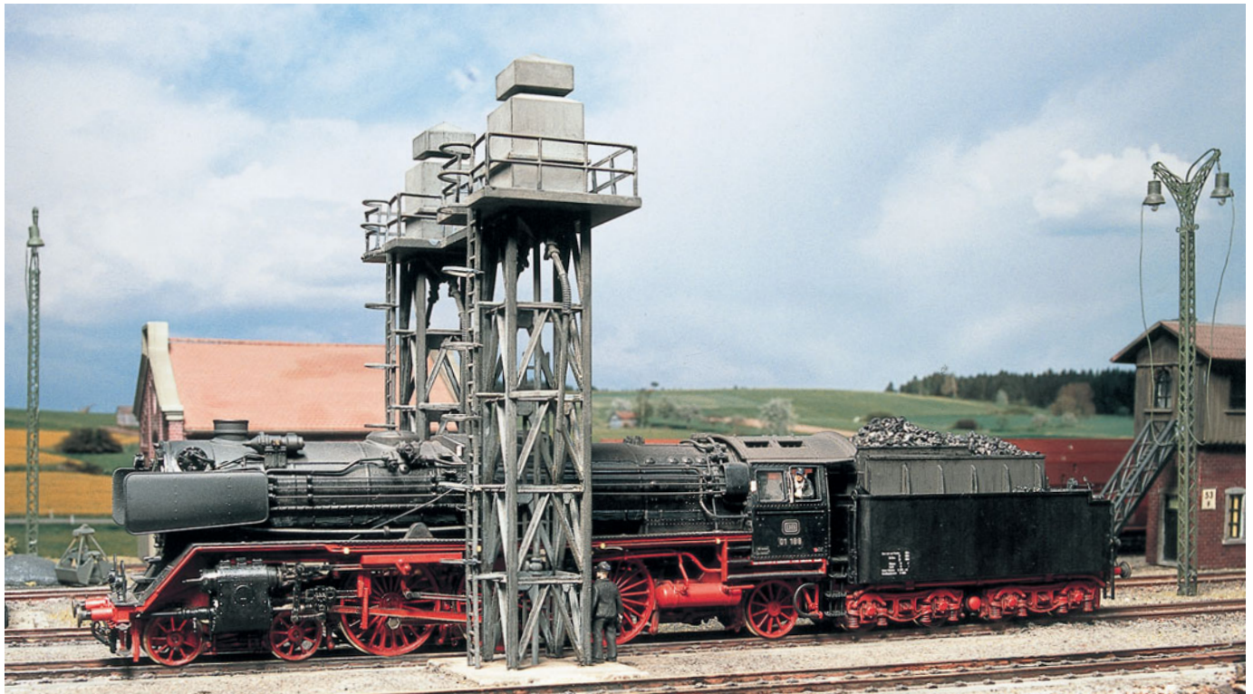
Unter dem Besandungsturm können die Bremsandsreserven aufgefüllt werden.
