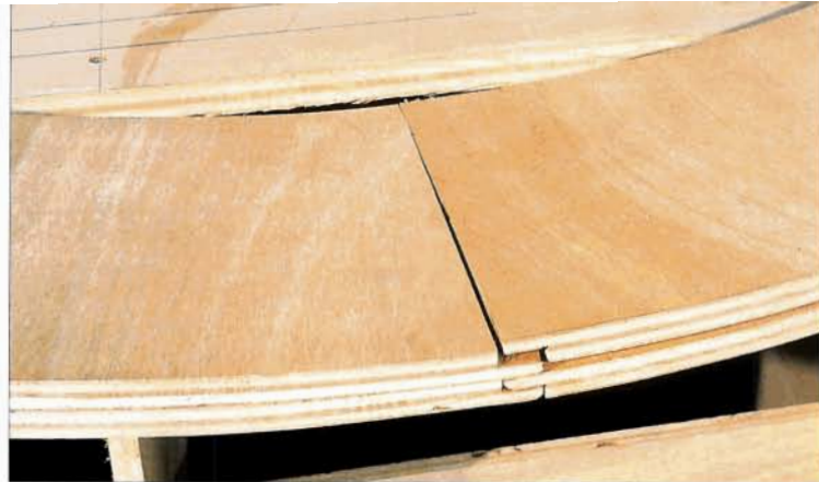
Bild 19: Kreisrund geschnittene und ausgefaltete Trassenelemente lassen sich zum Idealkreis verleimen.
