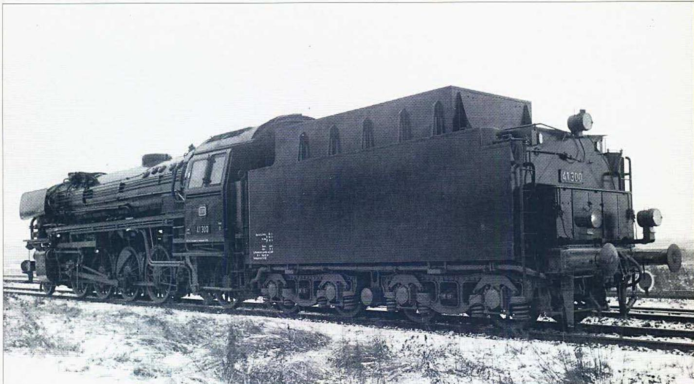
Um den neuen Kessel mit der größeren Gesamtlänge von 12 550 mm auf dem Rahmen unterbringen zu können, waren eine Verlängerung des Rauchkammerträgers und eine Verlegung der Pendelblechstützen erforderlich. Änderungen wurden auch im Bereich der Rauchkammer vorgenommen. Der neue Mischvorwärmer der Bauart MV 57 verlangte einen geänderten Verlauf der Ein- und Ausströmröhre. Daraus ergab sich eine Neugestaltung im vorderen Bereich des Umlaufs, bei der die Schrägbleche entfielen.
