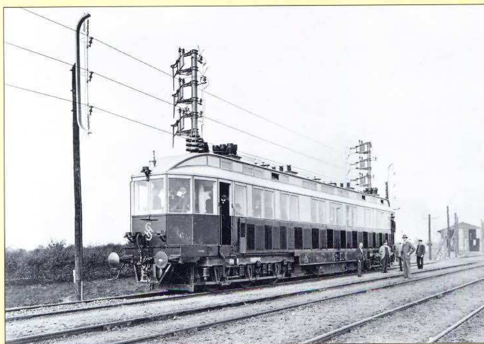
Bild 17: Der 206,7 km/h schnelle Siemens-Versuchstriebwagen in Marienfelde. Die Fahrleitung war an Holzmasten montiert. Abb. 16 bis 19: Siemens Forum München
