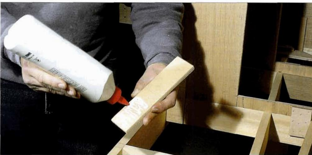
**Bild 16 (unten links):** Bis zum endgültigen Abbinden des Weißleims werden die Klebverbindungen zwischen den Geländespanten und den Holzstreifen mit Schraubzwingen gegen unbeabsichtigtes Verrutschen gesichert.
