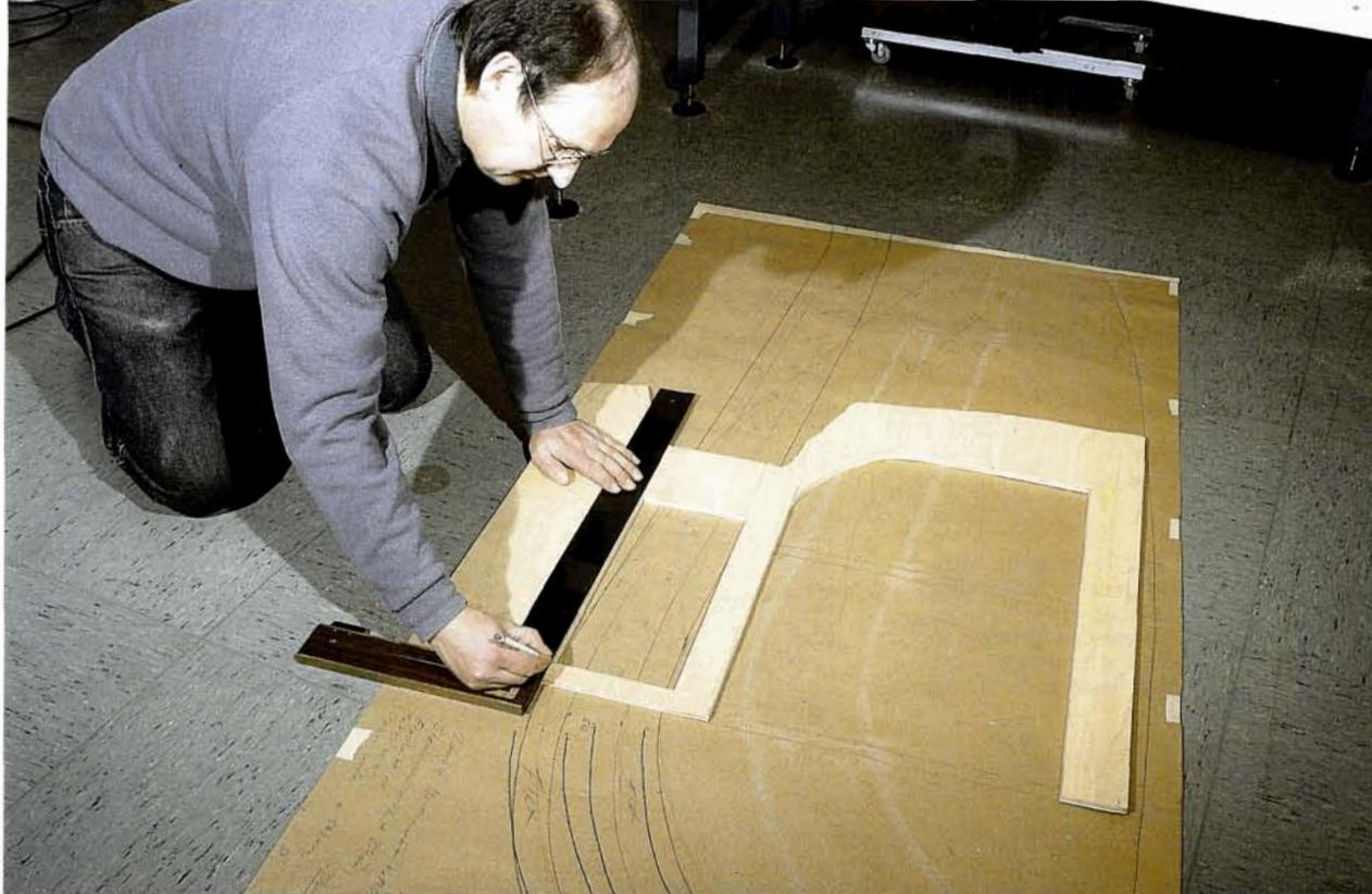
**Bild 14:** Noch muß der Fußboden als Arbeitsfläche dienen. Für das Übertragen der Geländespanten-Maße von den Bauzeichnungen auf das Sperrholz ist sorgfältiges und vor allem genaues Arbeiten unbedingt Voraussetzung.
