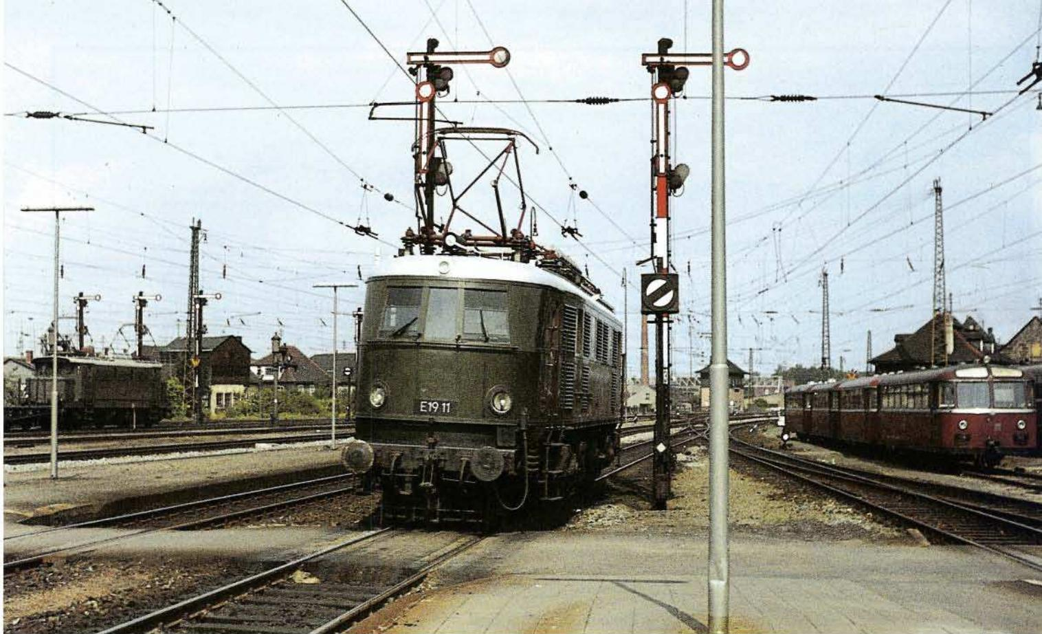
**Bild 11:** Der "Edelhirsch" E 19 11 (Bw Nürnberg Hbf), für den Schnellverkehr München – Berlin über die Frankenwalddrampe geschaffen, im Jahr 1965 im Bahnhof Lichtenfels. Links im Bild eine E 44 mit einem Güterzug, rechts von der E 19 eine VT 95-Garnitur der ersten Serie – noch mit Oberlichtern und "Motorradlampe" als drittem Spitzensignal (1965). **Abb.: G. Jahreis**
