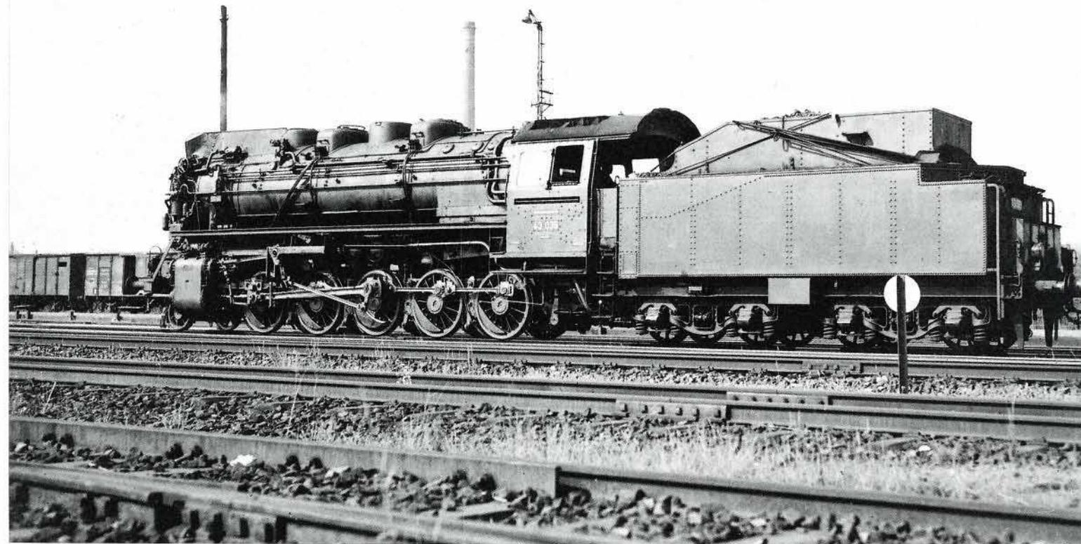
**Bild 7:** Die Lokomotiven der Baureihe 43 bekamen nur vereinzelt die großen Windleitbleche der Baureihe 01. Wie hier bei der 43 035 wurden verschiedene Formen von Windleiteneinrichtungen erprobt.
