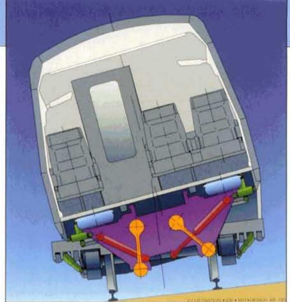
**Bild 8:** Drehgestell am Steuerwagen eines X 2 resp. X 2000 der SJ. **Abb.:** J. Hörstel
