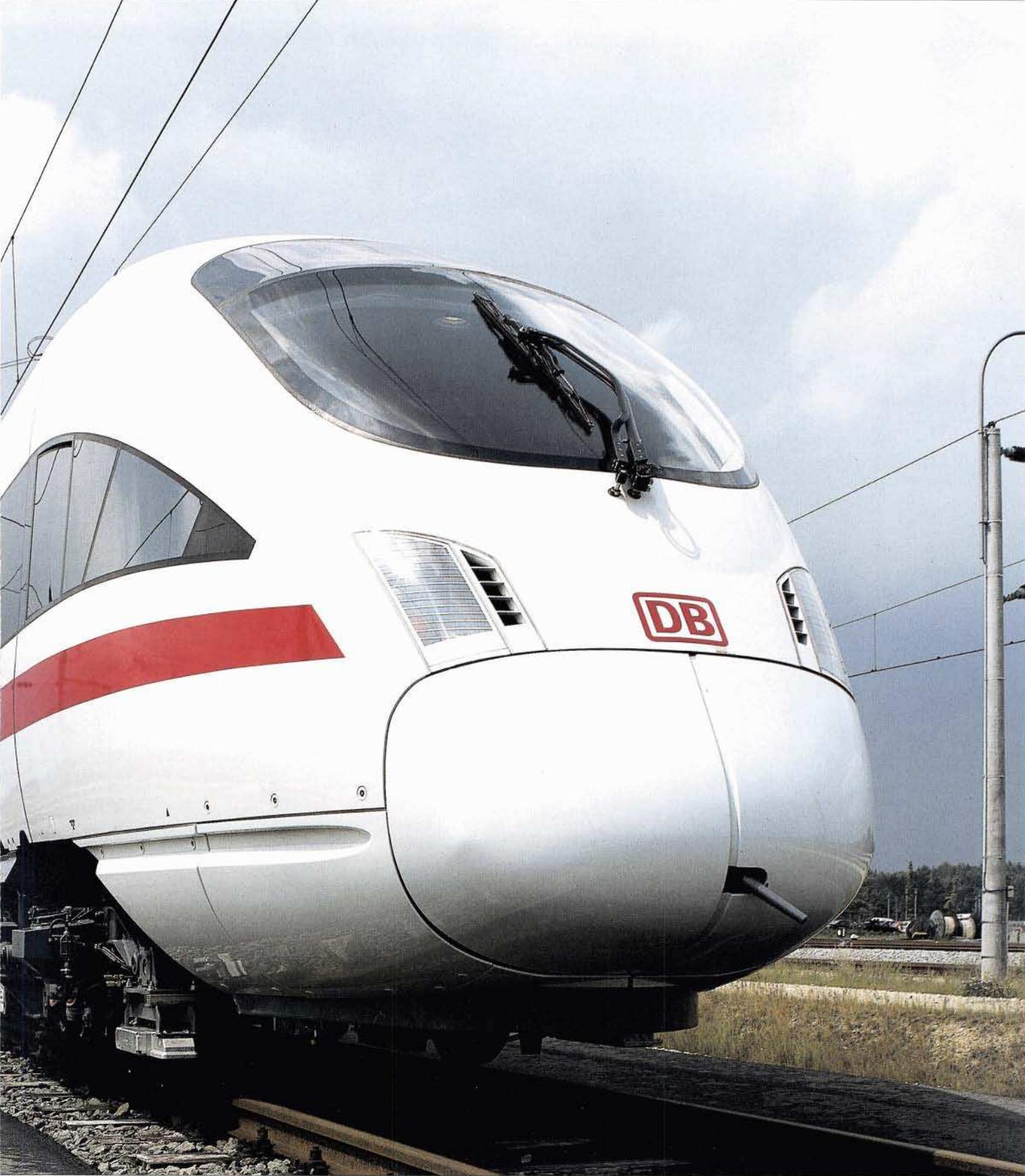
**Bild 12:** Mit einem neuen Design können auch ICE 3 und ICT (Foto oben im Siemens-Prüfzentrum Wegberg-Wildenrath) aufwarten. Weit bedeutender als die neue Frontgestaltung ist jedoch hier der Übergang vom Triebkopfzug- (ICE 1 und ICE 2) zum Triebwagen-Konzept. **Abb.: H. Schön**
