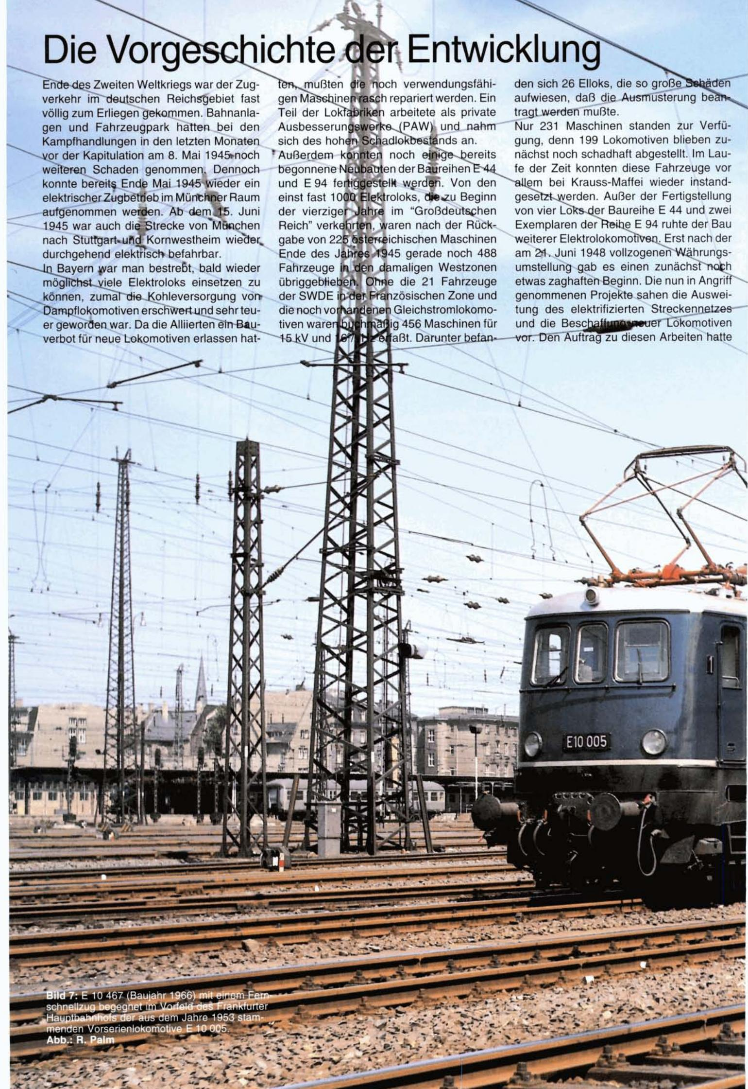
Bild 7: E 10 467 (Baujahr 1966) mit einem Fernschnellzug begegnet im Vorfeld des Frankfurter Hauptbahnhofs der aus dem Jahre 1953 stammenden Vorserienlokomotive E 10 005.
