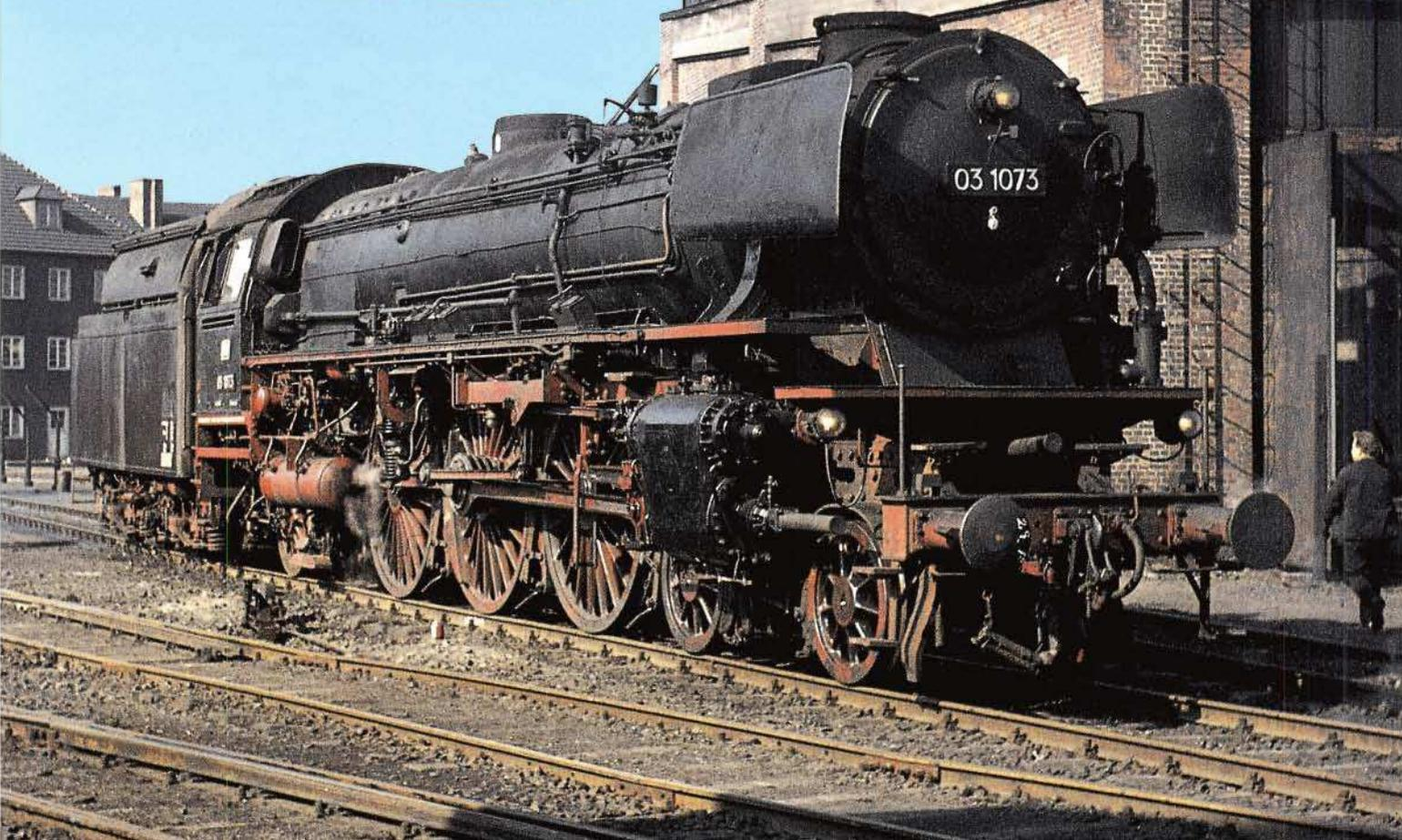
**Titelbild:** Die 60 Lokomotiven der Baureihe 03<sup>10</sup> wurden in den Jahren 1940 und 1941 mit Stromlinienverkleidung in Dienst gestellt (03 1081 in Wien West am 20. September 1940). Nach 1945 wurde die Stromlinienverkleidung bei den Lokomotiven der Deutschen Reichsbahn in der DDR sowie bei der Deutschen Bundesbahn entfernt (03 1073 im letzten Betriebszustand mit Ersatzkessel 1965 im Bw Hagen-Eckesey).
