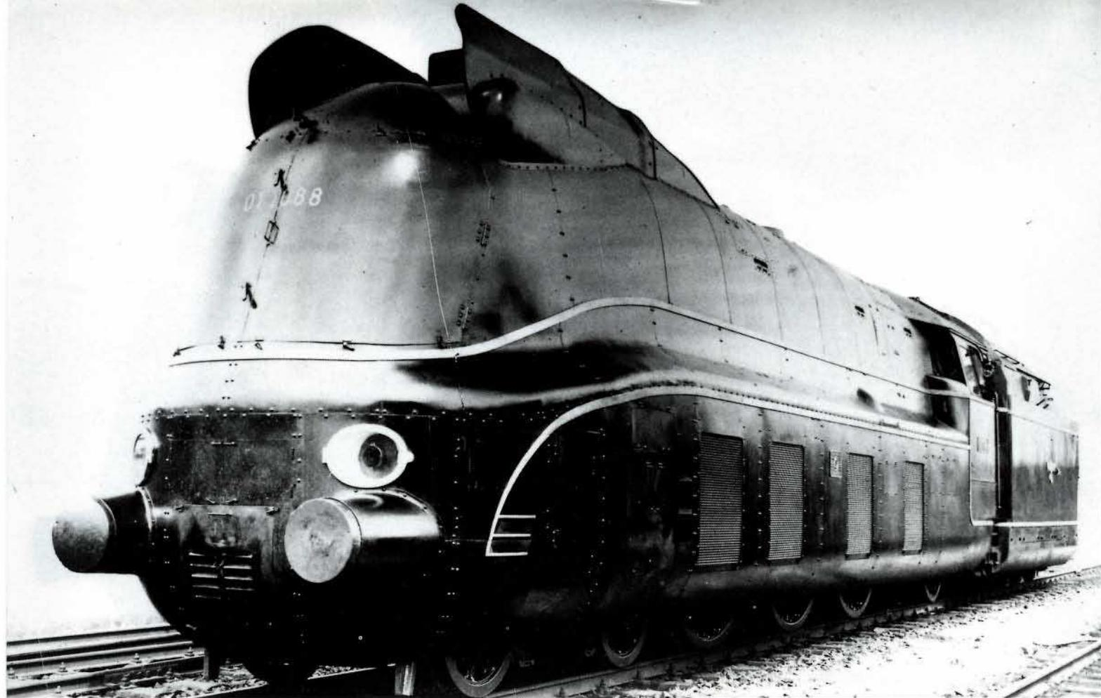
**Bild 9:** Sämtliche Lokomotiven der Baureihen 01<sup>10</sup> wurden von BMAG gefertigt und hatten bei der Ablieferung eine Vollverkleidung, die das ganze Triebwerk umschloß.
