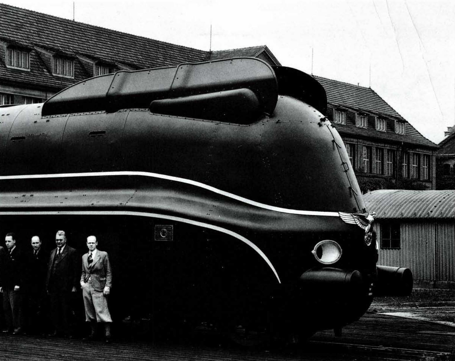
len Schnellzugverkehr nach Ansicht der Fachleute nur noch mit verkleideten Dreizylinder-Lokomotiven zu erzielen. Verkehrsexperten hatten einen Bedarf von 400 solcher Stromlinienlokomotiven ermittelt. Der Ausbruch des Zweiten Weltkriegs reduzierte nicht nur die Bestellung von 205 Maschinen auf gelieferte 55 Exemplare, sondern verhinderte auch nach nur kurzer Betriebszeit deren Einsatz im hochwertigen Reisezugdienst.
