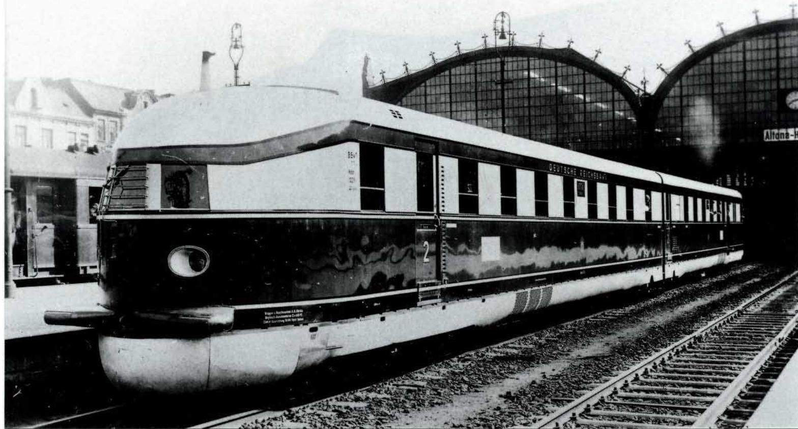
**Bild 5:** Der erste planmäßig eingesetzte dieselelektrische Schnelltriebwagen war der "Fliegende Hamburger". Bei der DRG lief er als VT 877a/b, bei der DB als VT 04.0. Das Fahrzeug war beim Bw Altona beheimatet. Das Foto zeigt ihn 1933 in Altona Hbf. **Foto: Sammlung Weisbrod**
