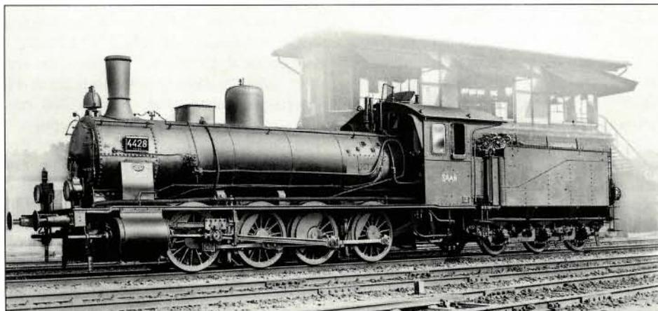
**Bild 5 (oben):** G 7<sup>2</sup> 2096 CASSEL, die Verbundauführung der vierfach gekuppelten Naßdampf-Güterzuglokomotive. Foto: Sammlung Weisbrod
