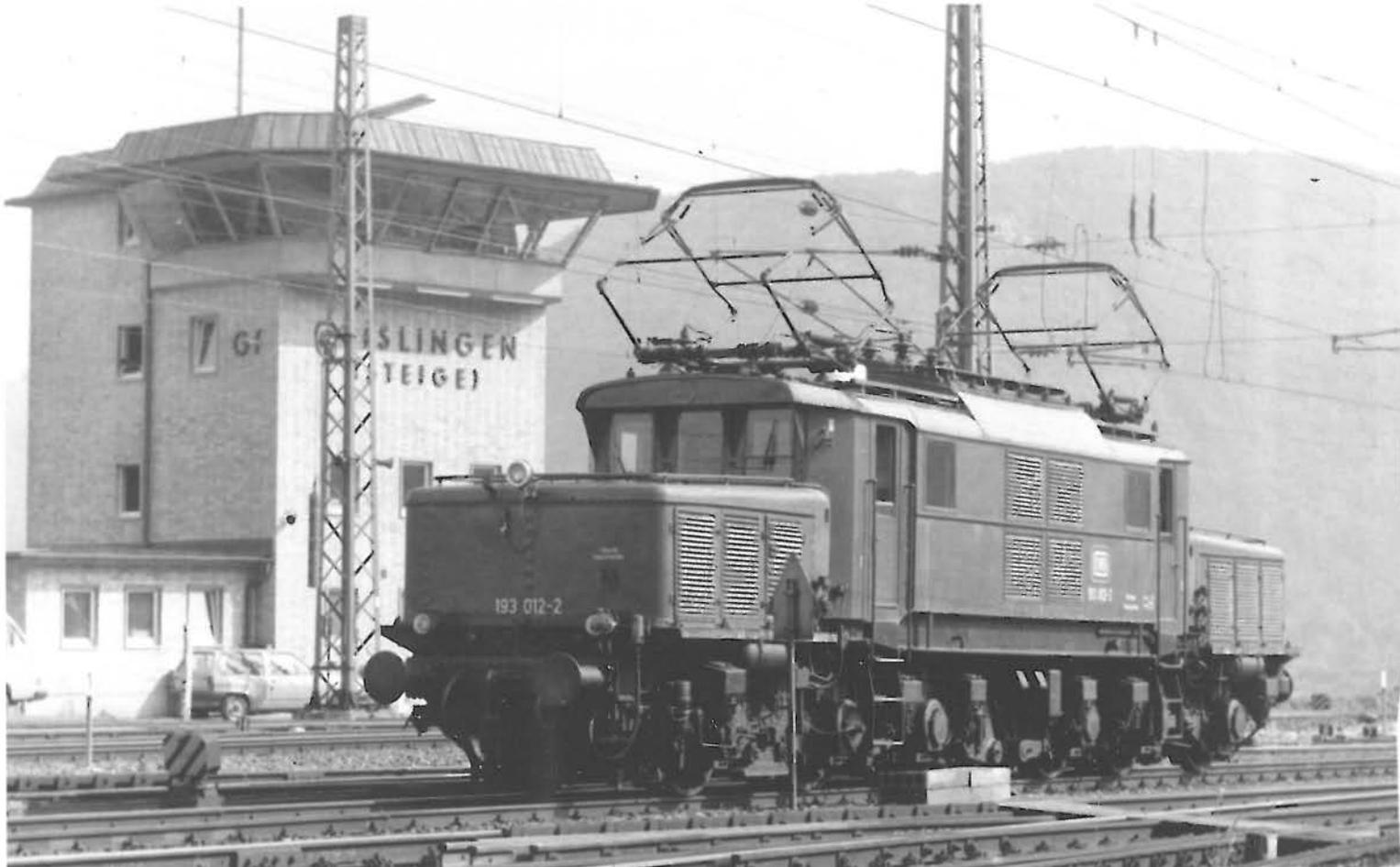
**Bild 8:** Für den Schiebedienst auf der bekannten Geislinger Steige wurden planmäßig Lokomotiven der Baureihe 193 eingesetzt. Hier wartet die 193 012, aufgenommen am 25. Juni 1983, auf neue Arbeit. **Foto: D. Kempf**
