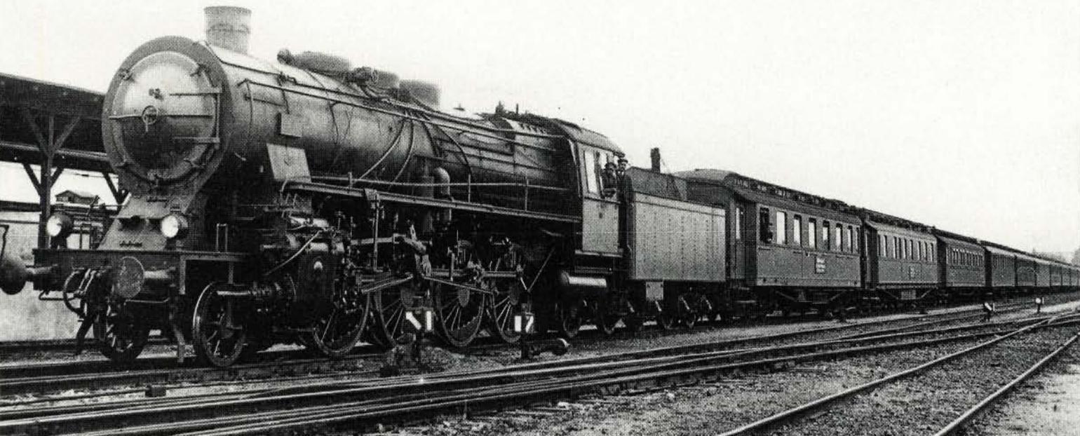
**Bild 14:** Mit der Elberfeld 2810 wurden zahlreiche Meßfahrten unternommen. Dieses Foto zeigt sie am 7. Juli 1922 in Lehrte mit fünfzehn vierachsigen Schnellzugwagen sowie einem fünfachsigen Meßwagen. Mit diesem Zug (Gewicht: 720 Tonnen) legte sie die 134 km lange Strecke von Lehrte nach Stendal in nur 88 Minuten zurück. Bei dem Schornstein handelt es sich um eine Versuchsausführung aus Blech.
