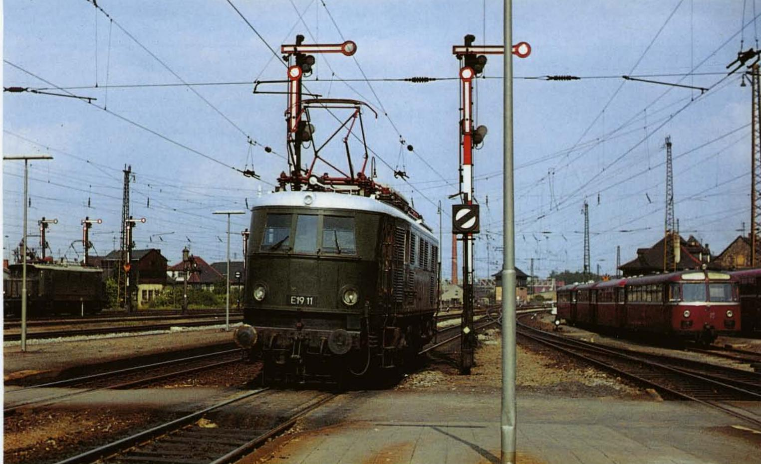
**Bild 11:** Der „Edelhirsch“ E 19 11 (Bw Nürnberg Hbf), für den Schnellverkehr München – Berlin über die Frankenaldrampe geschaffen, im Jahre 1965 im Bahnhof Lichtenfels. Links im Bild eine E 44 mit einem Güterzug, rechts von der E 19 eine VT 95-Garnitur der ersten Serie – noch mit Oberlichtern und „Motorradlampe“ als drittem Spitzensignal (1965).
