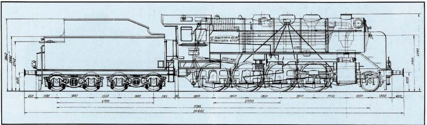
**Bild 6:** Entwurf einer 1'D-h2-Güterzuglokomotive der Firma Henschel & Sohn, Kassel.
