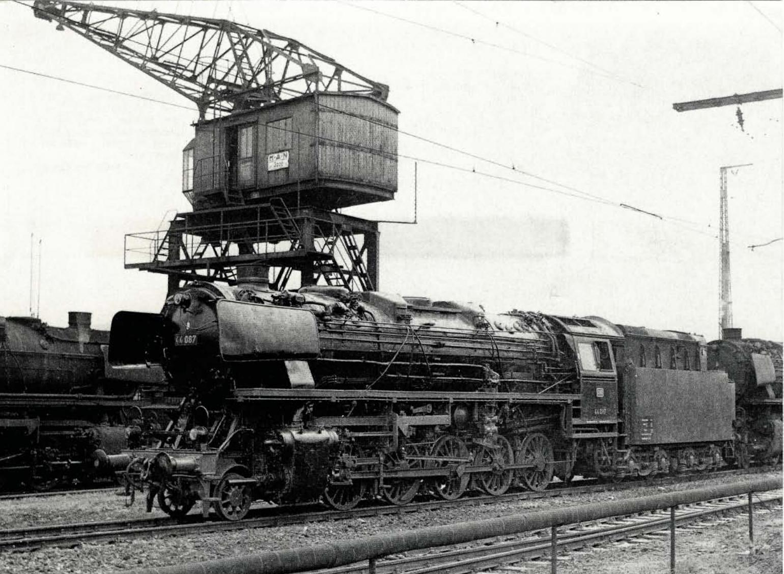
**Bild 13:** Nach dem Umbau auf Ölfeuerung blieben zunächst alle Lokomotiven der Baureihe 44 Öl beim Bw Bebra eingesetzt. Dort entstand dieses Foto im Juni 1965. **Foto: Reed**
