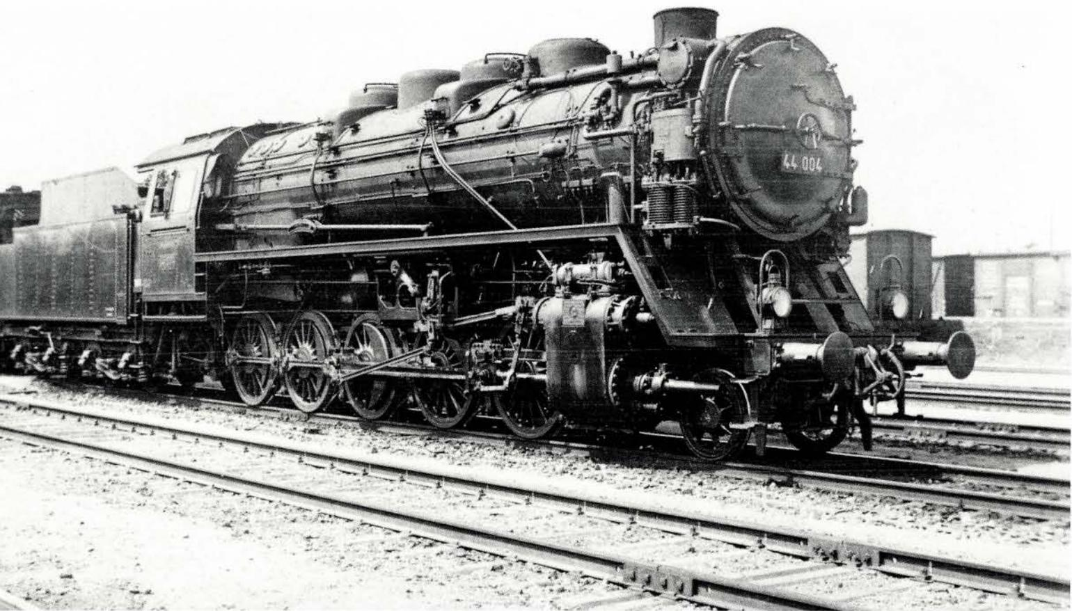
**Bild 5:** Vorserienlokomotive 44 004, Fabrik-Nr. 8 529 der Berliner Maschinenbau AG, BMAG, Baujahr 1926. Die ersten 10 Lokomotiven hatten noch eine höhere Kessellage und höhere Dome.
