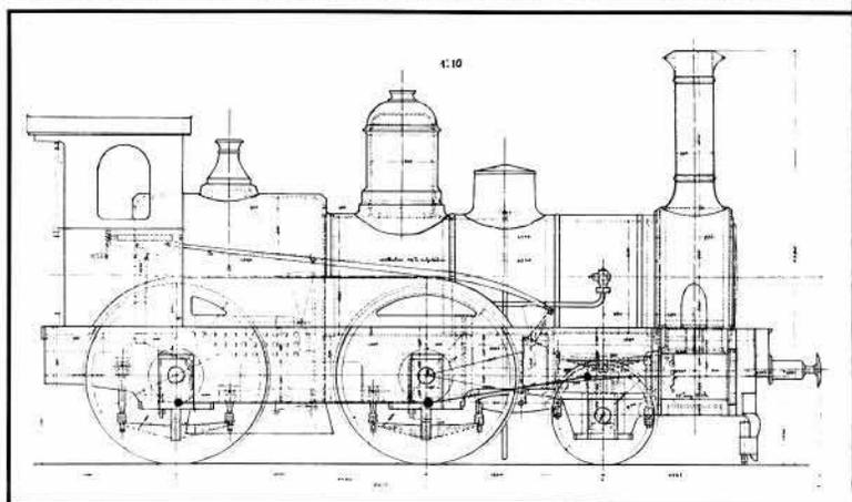
**Bild 8:** Schnellzuglok der Rheinischen Eisenbahn, entworfen 1876 in der „Central-Werkstätte der Rheinischen Eisenbahn zu Nippes bei Köln“. **Zeichnung: Sammlung Perillieux**
