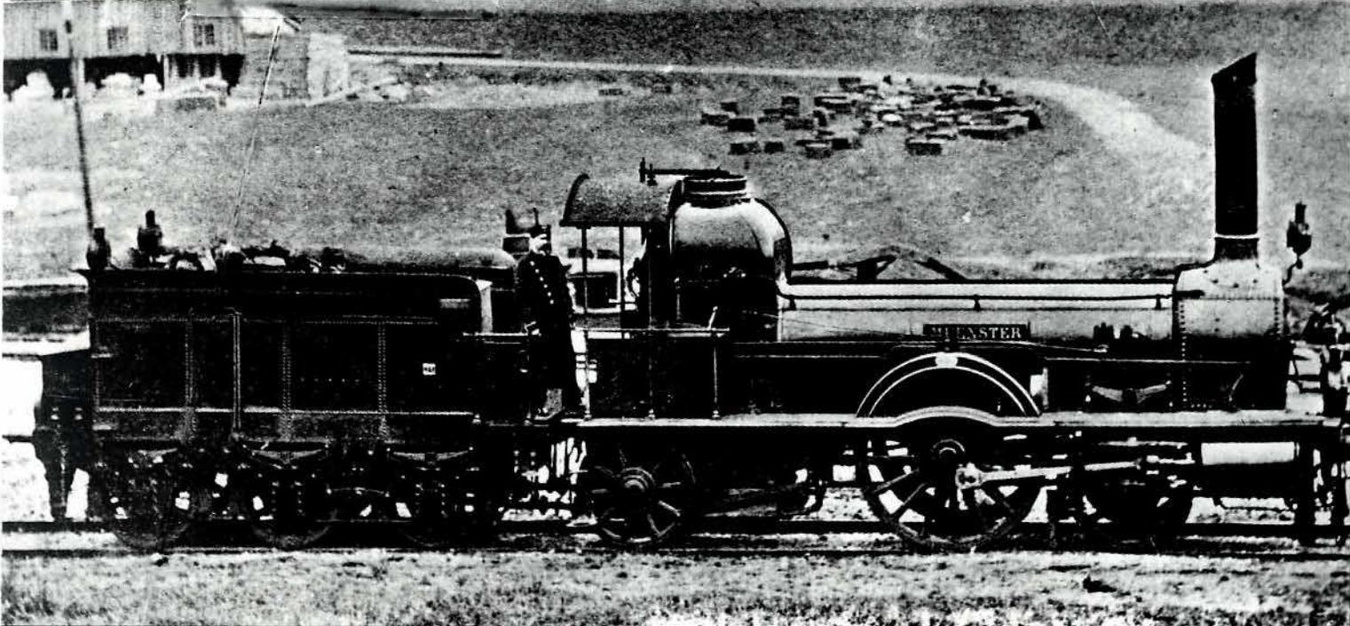
**Bild 7:** Für die Köln-Mindener Eisenbahn hat Kessler 1848 noch in seiner Werkstätte in Karlsruhe als Fabriknummer 101 die „Münster“ gebaut. Sie hatte zunächst einen überhängenden Stehkessel, erst 1851 wurde die hintere Laufachse nach rückwärts versetzt, um so einen längeren Radstand zu erreichen. **Foto: Sammlung Dr. Scheingraber**
