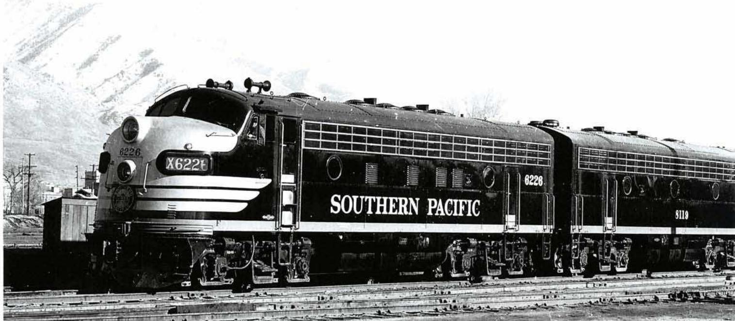
Bild 8: Vier Einheiten der F-Reihe (Serie F7, Baujahr 1949) mit zusammen knapp 6000 PS um 1960 in Ogden, Utah. Abb.: Tom Klinger Collection
