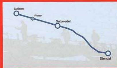
für das **Projekt 3** ein Ausbau Stendal – Salzwedel und ein Neubau Salzwedel – Wieren erforderlich. Im Dezember 1997 ist die Ausbaustrecke Stendal – Salzwedel (73 km) eingleisig, elektrifiziert und mit moderner Betriebsleittechnik (ein elektronisches Stellwerk) an die DB AG übergeben worden. Damit ist der Streckenausbau in Sachsen-Anhalt im wesentlichen abgeschlossen.
