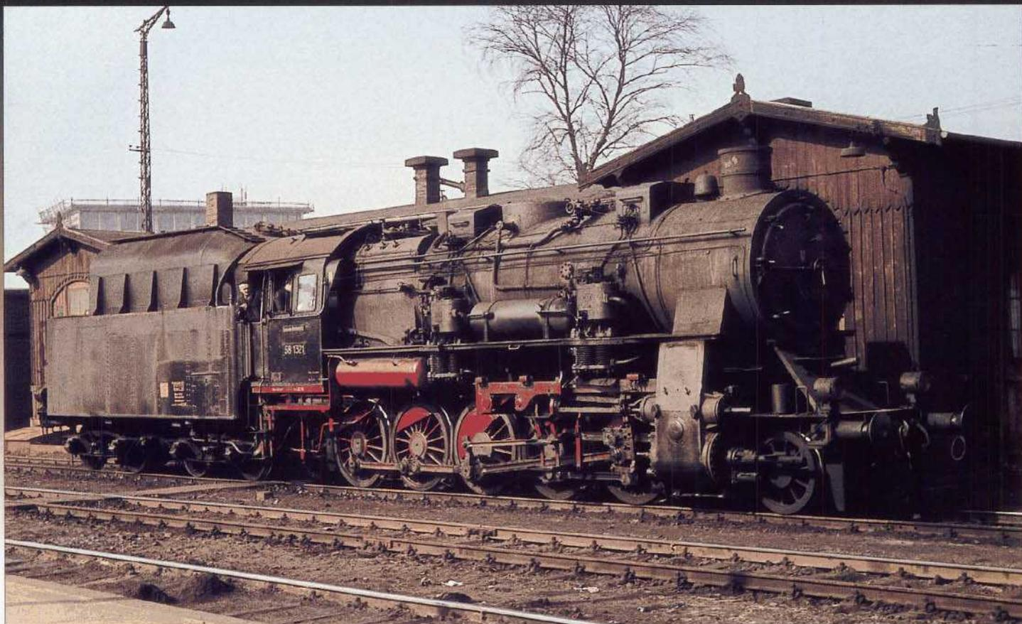
lenstaub einen längeren Ausbrennweg zu geben, hatte man erstmals bei einer deutschen Lokomotive eine Feuerbüchse mit Verbrennungskammer vorgesehen, doch es gelang nicht, dem Flammenweg die langgestreckte S-Form zu geben, die für das Ausbrennen der Staubteilchen erforderlich gewesen wäre.
