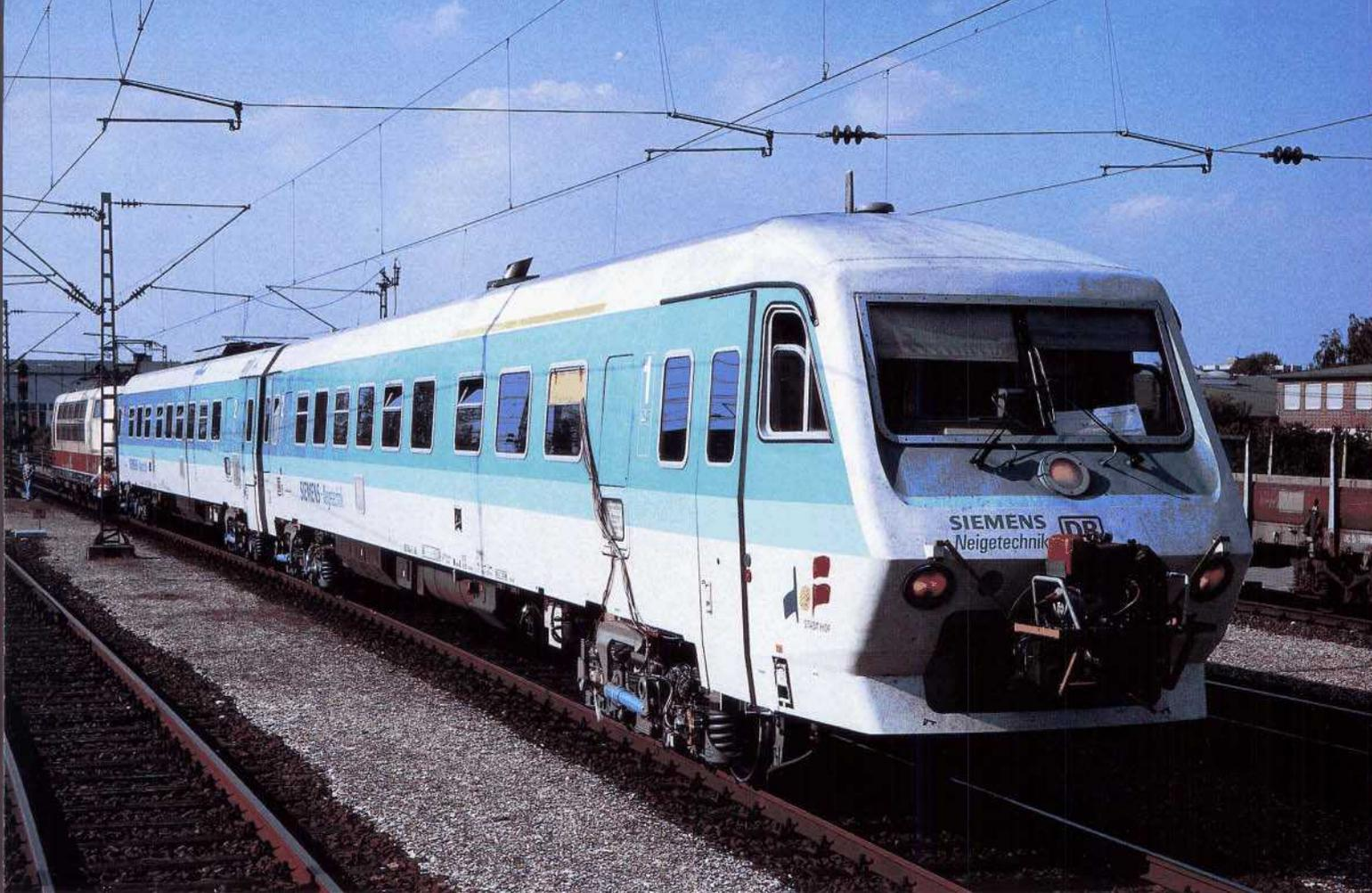
**Oben:** Der zum Testzug 610K mit Komponenten der neuen Siemens-Komfort-Drehgestelle umgerüstete 610 004/504 bei Hochgeschwindigkeitsfahrten im Raum Hannover am 15. August 1997.
