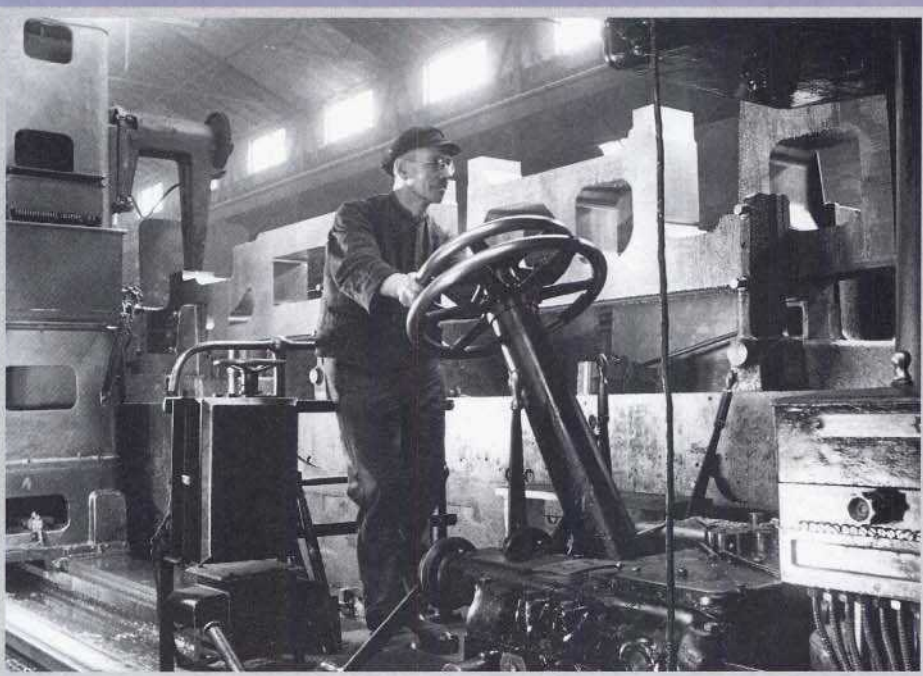
Aus dem gewaltigen Rohling entstehen drei Rahmenwagen (Mitte). – Bei den Schweißarbeiten am Rahmen eines 50er-Tenders 2'2' T 26 sind dessen Drehgestellhalter gut zu erkennen (oben). – Nach dem Einbau der Feuerbüchse werden Stehbolzenlöcher in den Kessel gebohrt (rechts). – Ein bereits mit Aschkasten versehener Kessel wird zum Fahrgestell transportiert (rechte Seite oben; im Vordergrund eine Radsatzgruppe.) – Erstes Anheizen und Funktionsprüfung der 50 1305 in der Heizhalle.
