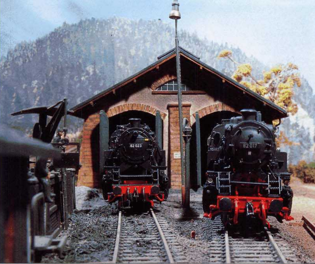
Bild 5: Während der Sonntagsruhe stehen gleich zwei 82er nebeneinander vor dem Schuppen. Interessant sind die unterschiedlichen Bauarten der Vorwärmer: Während 82 023 (Piko-Modell) einen Henschel-Mischvorwärmer besitzt, ist die 82 017 (M+F-Modell) mit einem Oberflächenvorwärmer der Bauart Knorr ausgerüstet.
