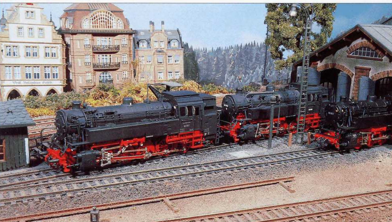
Bild 7: In einer anderen Betriebspause stehen sogar drei Neubauloks vor dem Schuppen. Bei 82 004 wurde noch kein Vorwärmer eingebaut. Der Einbau ist jedoch anlässlich einer L 0 für Anfang 1955 vorgesehen. Alle Abb.: MV-HS
