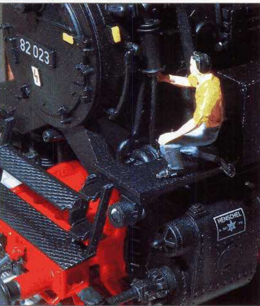
Bild 5: Während der Sonntagsruhe stehen gleich zwei 82er nebeneinander vor dem Schuppen. Interessant sind die unterschiedlichen Bauarten der Vorwärmer: Während 82 023 (Piko-Modell) einen Henschel-Mischvorwärmer besitzt, ist die 82 017 (M+F-Modell) mit einem Oberflächenvorwärmer der Bauart Knorr ausgerüstet.
