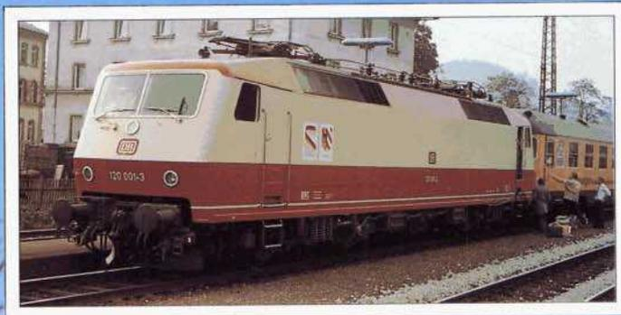
**Bild 7:** Die ebenfalls 1980 in Dienst genommene 120 001 stellte vier Jahre später einen neuen Weltrekord für Drehstromlokomotiven mit Asynchron-Fahrmotoren auf. **Foto: H. Obermayer**
