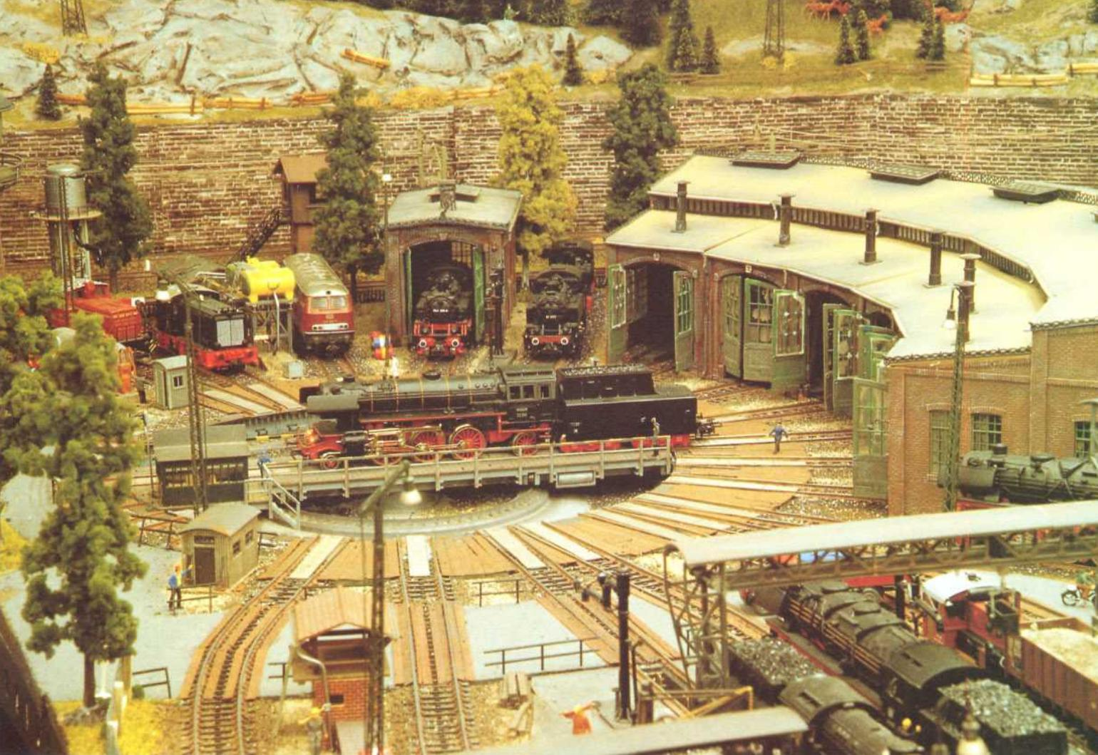
**Bild 7:** Der zentrale Punkt fast aller Bahnbetriebswerke: die Drehscheibe. Klar erkennbar ist der Typ des Bw: ein Bw für Dampf- und Diesellokbetrieb, warten doch auf den Aufstellgleisen Lokomotiven aller drei Traktionsarten.
