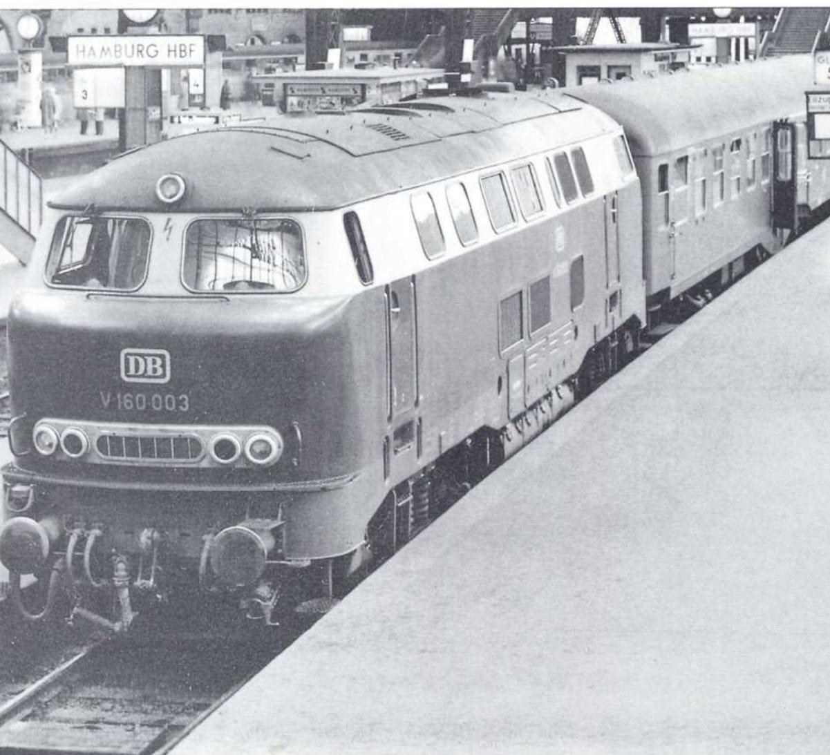
**Bild 4:** Dieses Foto aus dem Jahre 1962 zeigt die heutige Museumslokomotive V 160 003 noch mit der ursprünglichen Lüfterzahl.
