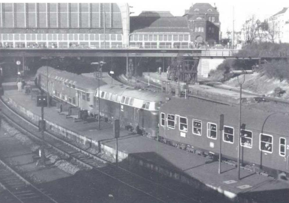
**Bild 6:** Mit einer Wendezuggarnitur, die auf der Lokseite durch einen zweiteiligen Doppelstockwagen verstärkt wurde, ist die V 160 007 hier unterwegs (Hamburg Hbf im November 1962).
