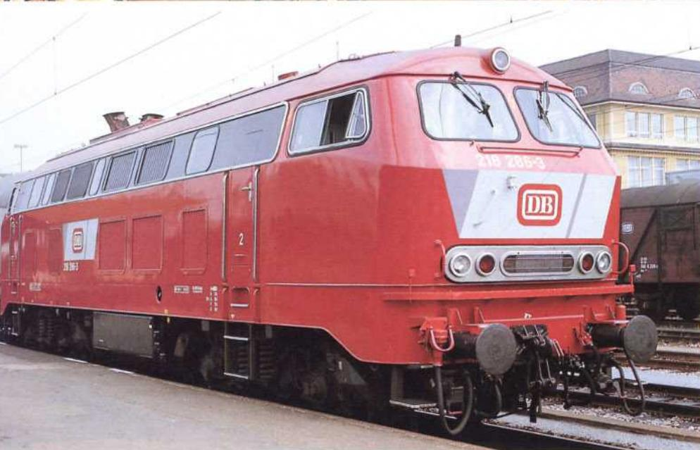
Mit dem Bau der Fahrzeuge der Reihe 218 war die Entwicklung der Großdiesellokomotiven für die Deutsche Bundesbahn abgeschlossen. Der Wandel von der dampfgepeisten zur elektrischen Zugheizung war vollzogen, die großen Antriebsaggregate mit zwölf Zylindern und mit Nennleistungen bis zu 2500 PS hatten die Serienreife erlangt. Nach den Prototypen 218 001 bis 012, in den
