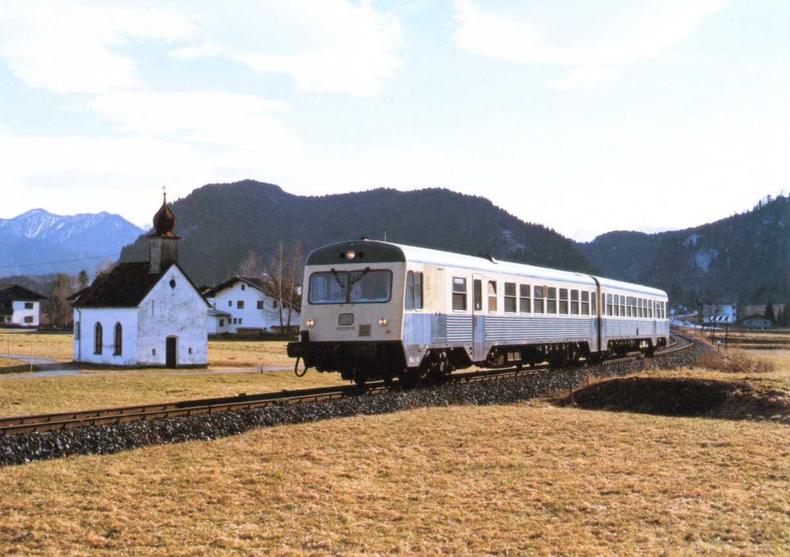
**Bild 5:** Aus betrieblichen Gründen dürfen nur zweimotorige Garnituren der Baureihe 628.0 auf der Außerfernbahn (Reutte in Tirol – Garmisch-Partenkirchen) eingesetzt werden. Bei Musau war am 14. Januar 1988 der 628 002 mit einem weiteren Motorwagen unterwegs. **Foto: K. Eckert**
