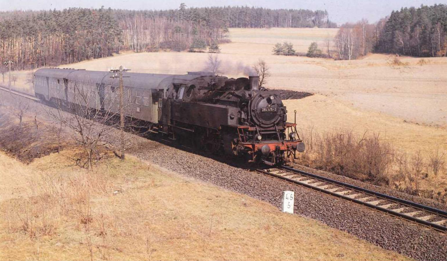
**Bild 4:** Vor einem Personenzug von Bayreuth nach Kirchenlaibach wurde hier die 064 415 bei Seybothenreuth im Bild festgehalten. Die Lokomotive entstammt einer Lieferserie, die an Treib- und Kuppelrädern mit Scherenbremsen ausgerüstet wurde. Foto: U. Geum
