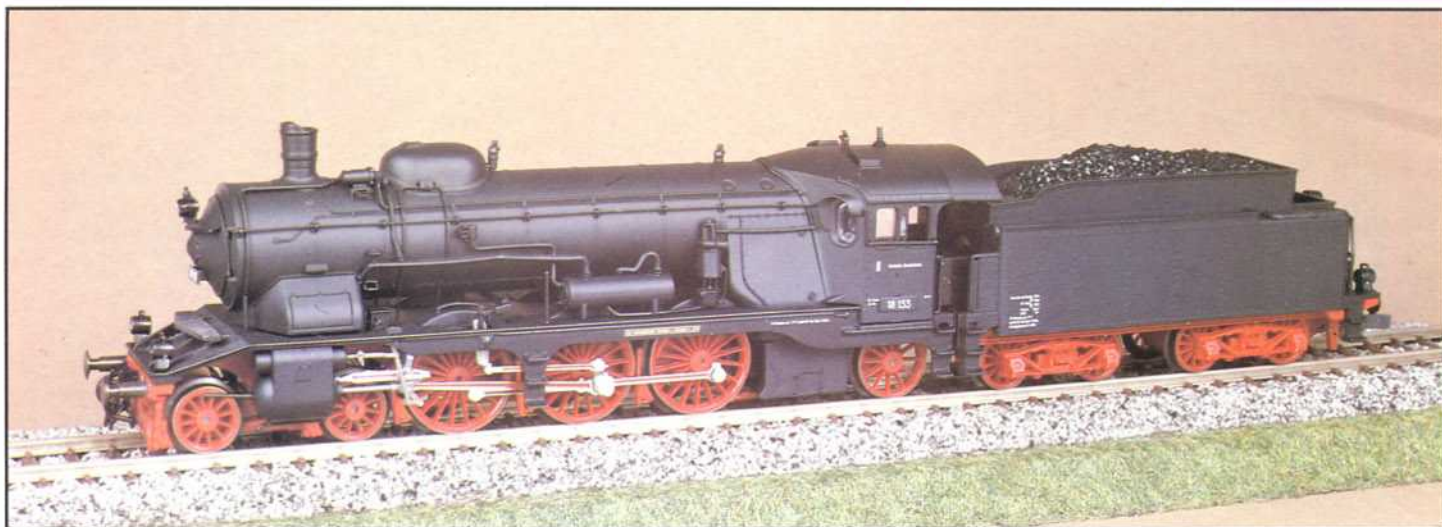
Bild 15: Zu den zahlreichen Änderungen und Ergänzungen gegenüber der Länderbahnlokomotive zählt auch die Vorwärmanlage auf dem linken Umlauf.
