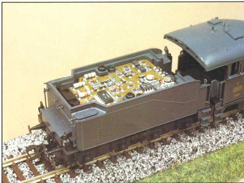
Bild 6: Unter dem Kohleneinsatz der C von Märklin hat die reich bestückte Leiterplatte ihren Platz gefunden. Beschleunigung und Höchstgeschwindigkeit sind individuell variierbar.
