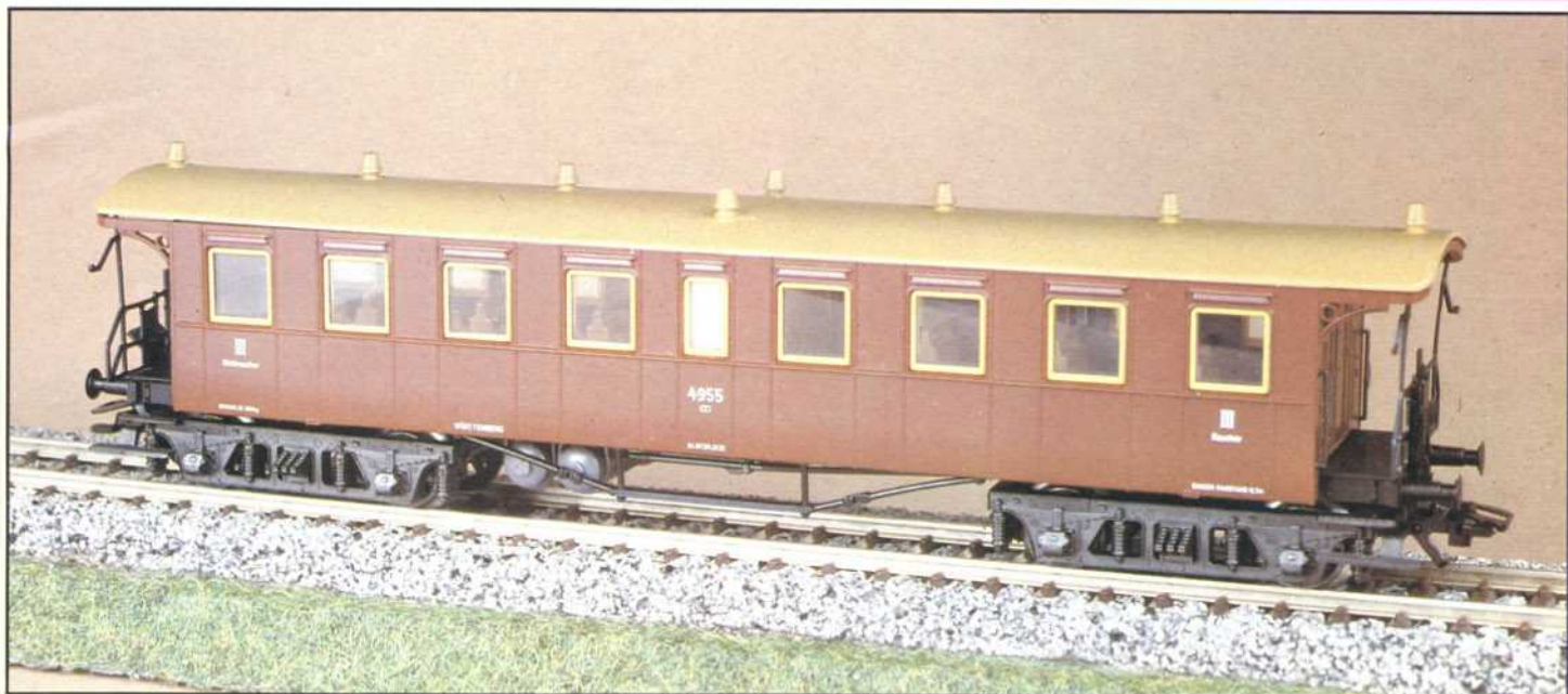
Bild 7: Württembergischer Durchgangswagen III. Klasse mit sehr gut ausgeführten Drehgestellen und klappbaren Übergangsblechen.
