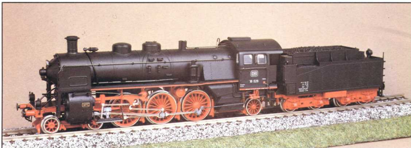
Bild 10: Die etwas schlichte 18 528 der DB, die als erste Lok von Rivarossi mit dem neuen Antrieb "S-Drive" ausgerüstet wurde.
