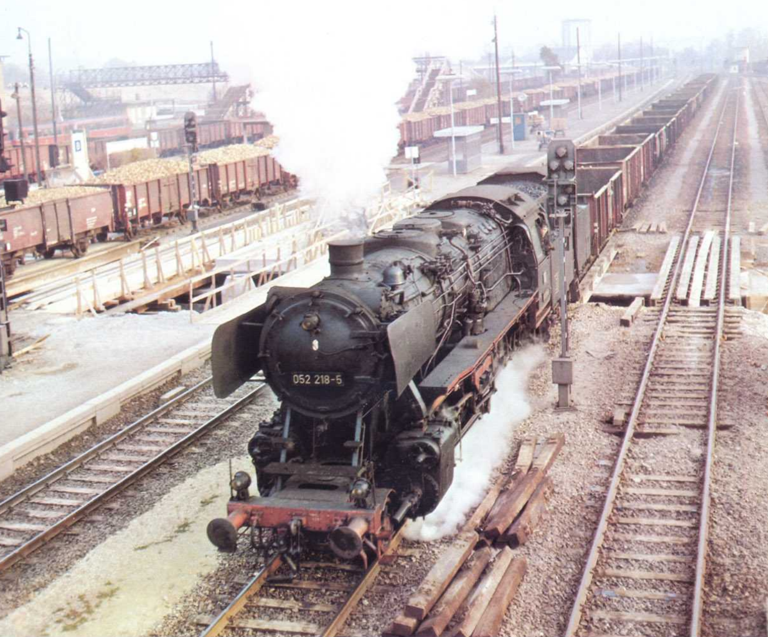
Bild 8: Zuckerrüben-Züge in Bad Friedrichshall-Jagstfeld auf einer Fotografie vom Oktober 1970. Die 052 218 aus dem Bw Heilbronn verfügt über drei Dome und eckig ummantelte Einströmrohre. Foto: H. Obermayer
