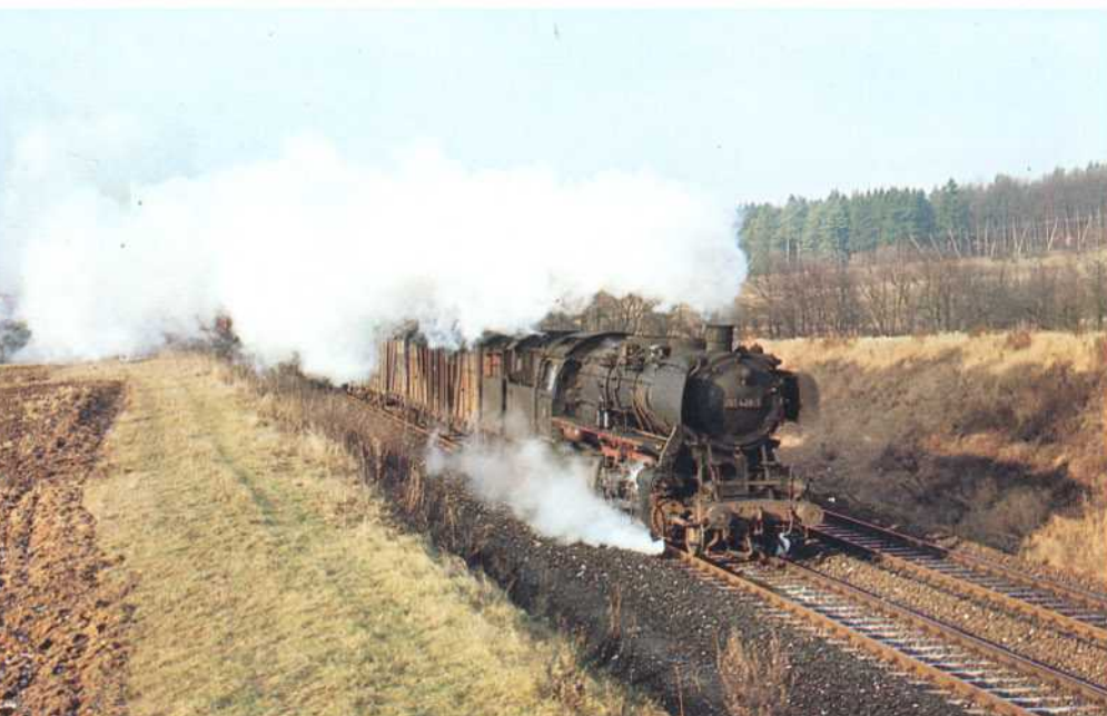
Bild 5: Die Deutsche Bundesbahn baute zu Beginn der sechziger Jahre in 730 Tender der Bauart 2'2' T 26 Kabinen für den Zugführer ein. Zu den Lokomotiven der Baureihe 50, die mit einem solchen Kabinentender gekuppelt waren, zählt auch die abgebildete 051 428.
