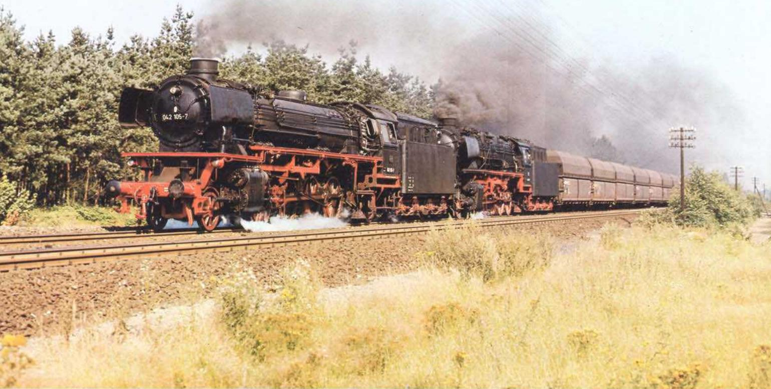
**Bild 8:** Auch als Vorspannlokomotiven vor schweren Güterzügen konnte man die ölgefeuerten 41er auf der Emslandstrecke beobachten. Die Aufnahme mit der 042 105 entstand am 29.08.1972. Foto: U. Geum
