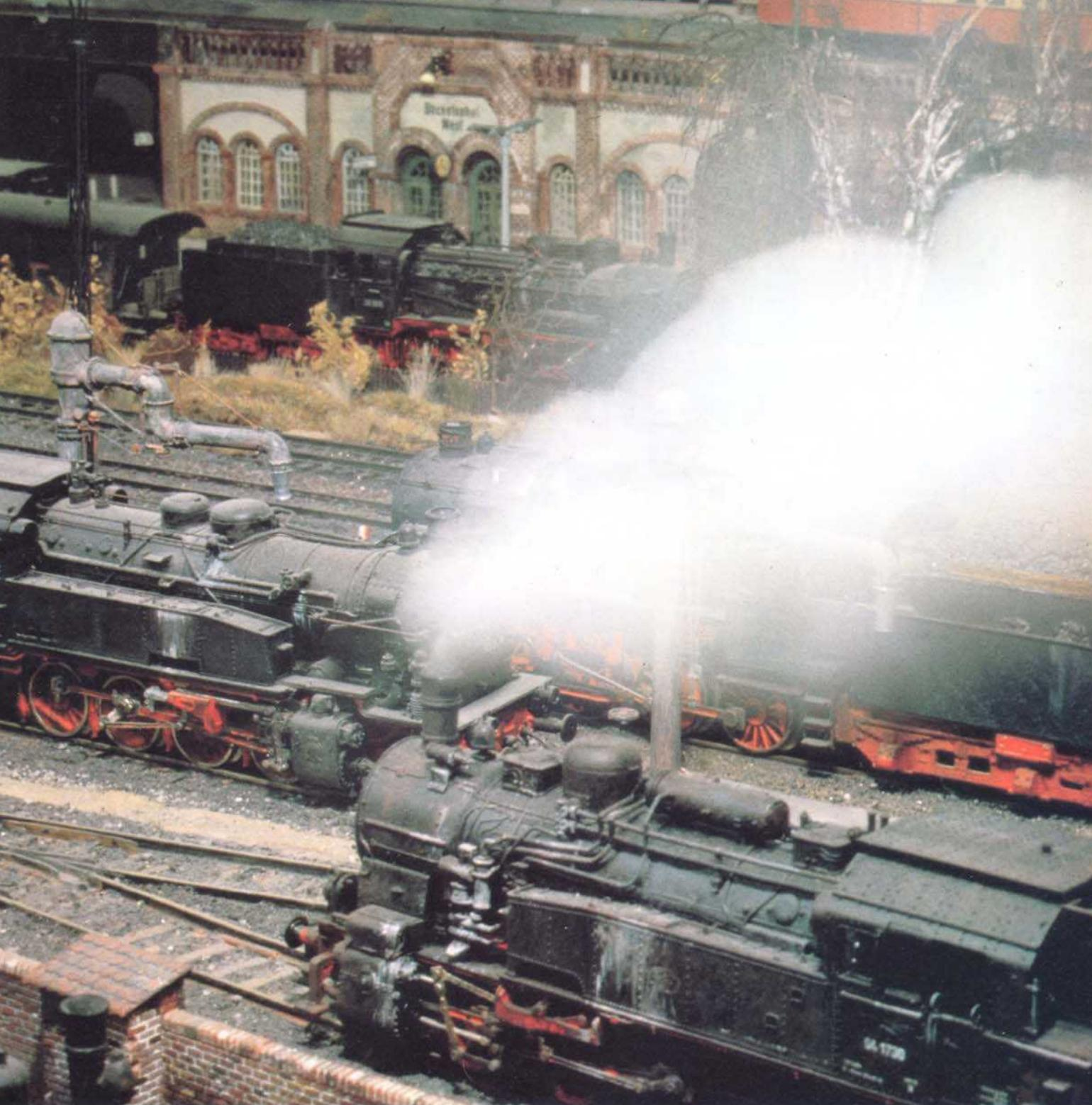
Bild 9: Gefahren wird mit dem betriebssicheren Dreileiter-Gleichstrom-System. Dabei übernehmen geschickt getarnte "Nemec" (heute Schullern)-Stifte die Funktion des Mittelleiters.
