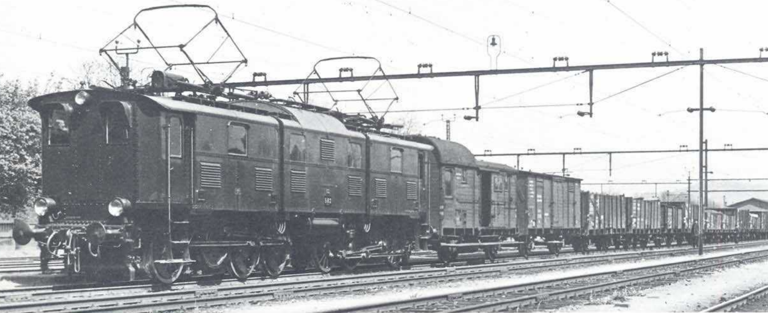
Bild 4: Die Lokomotive mit der Betriebsnummer EG 582 vor einem Güterzug im Bahnhof Hirschberg in Schlesien. Die 14 für den Einsatz in Schlesien gebauten Maschinen besaßen keine Stirnwandtüren, keine Übergangseinrichtungen und nur zwei Stirnfenster. Foto: Sammlung Dr. Scheingraber
