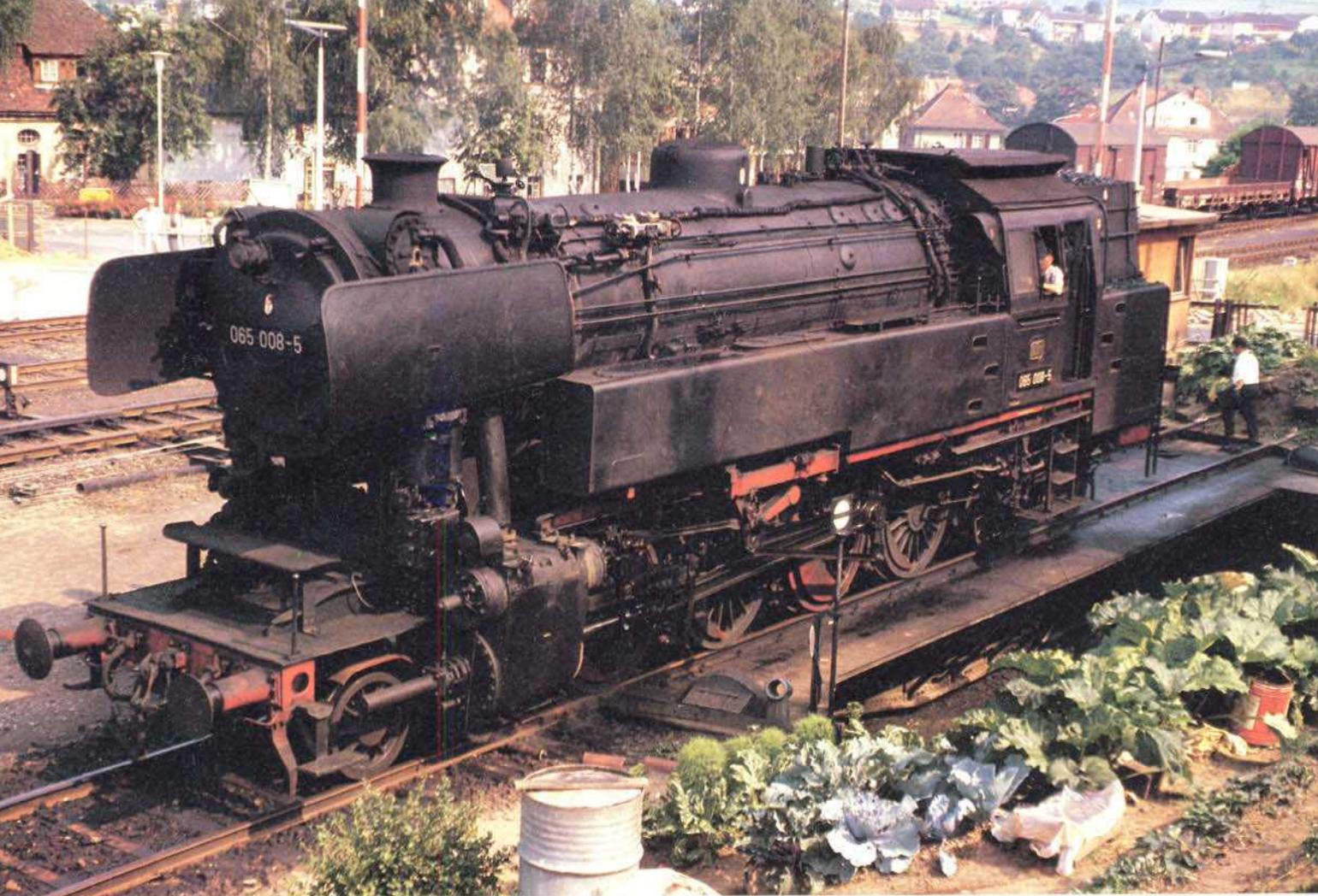
**Bild 15:** Die 065 008 ist mit dem P 3522 in Erbach/Odenwald eingetroffen und wird nun auf der dortigen Drehscheibe gedreht. Die Drehscheibe wurde übrigens mit der Druckluftpumpe der Lokomotive angetrieben (Sommer 1969).
