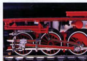
Das feine Fahrwerk unseres Modells zeigt die von der Serienmaschine abweichende Ausführung der nur teil- weise genutzten Kuppelstangen.
