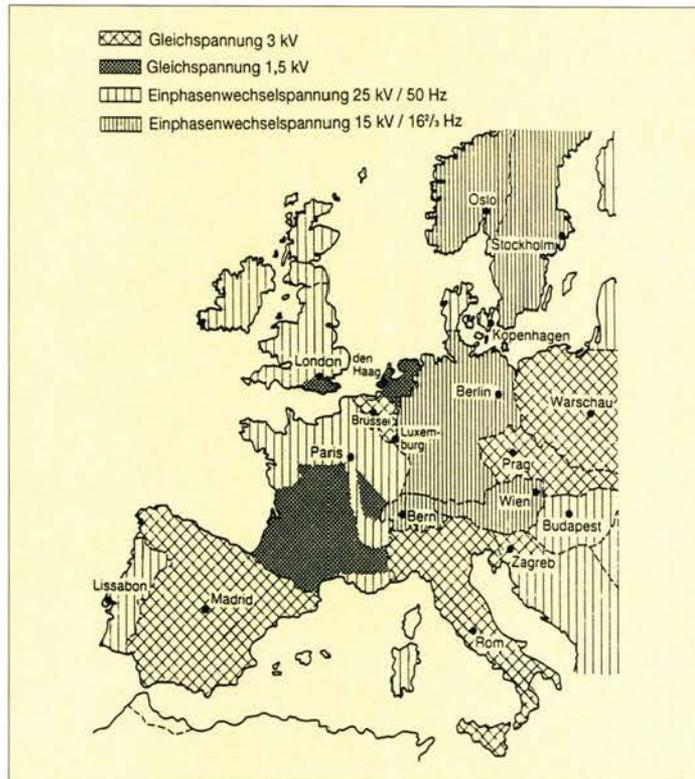
Die europäischen Bahnstromsysteme. Inselbetrieb mit 25 kV 50 Hz gibt es in Spanien auf der regelspurigen Hochgeschwindigkeitsstrecke Madrid-Sevilla, auf einigen Strecken in Tschechien und in Deutschland allerdings nur auf der bekannten Rübeldambahn im Harz.
