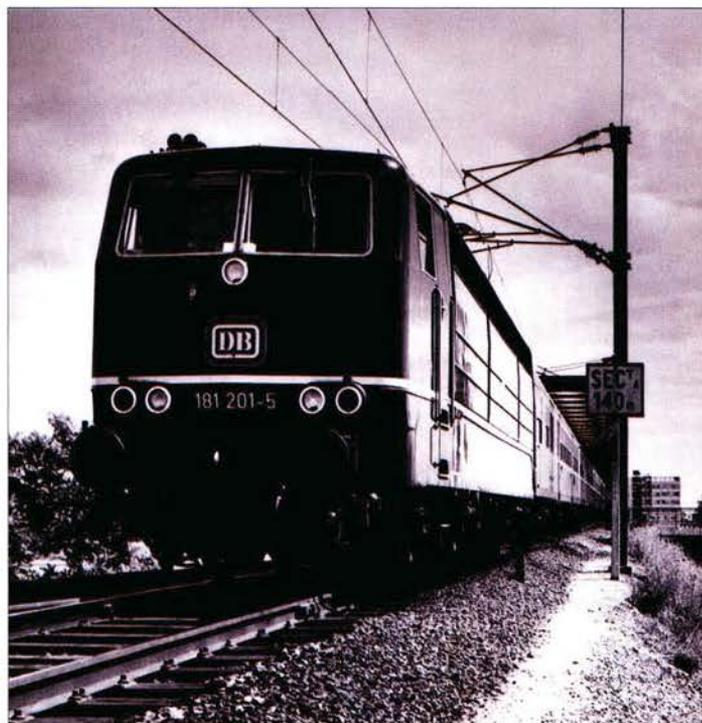
Zweifrequenzlokomotive der DB (15 kV 16 2/3 Hz/25 kV 50 Hz) beim Überfahren der Systemstoßstelle vor der Rheinbrücke in Kehl, 1979.
