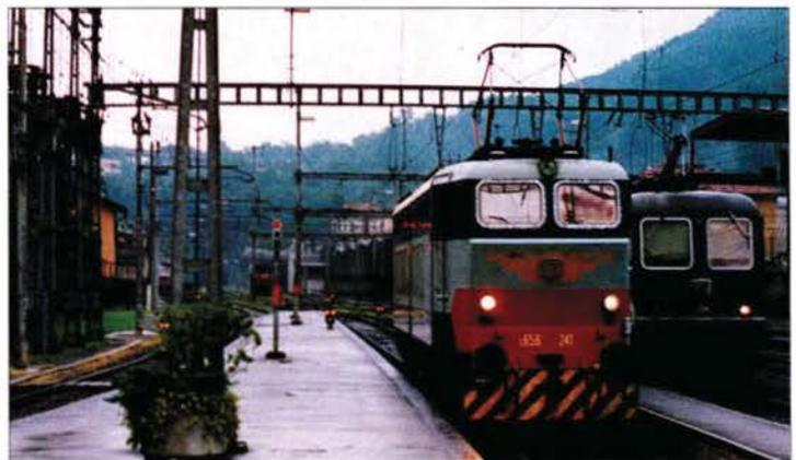
**Systemwechselbahnhof Chiasso: Italienische Gleichstromlok (links) und schweizerische Wechselstromlok, beide mit angelegten Stromabnehmern bei entsprechend geschalteten Fahrleitungen.**
