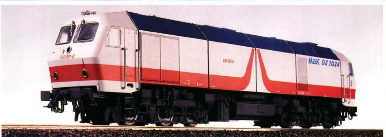
Das Vorbild: MaK De 1024, BR 240, 120 t schwer, ist die stärkste je in Deutschland gebaute Diesellok. 1990 wurden die von der Firma Krupp-MaK gebauten Loks an die DB zur Erprobung ausgeliefert.
