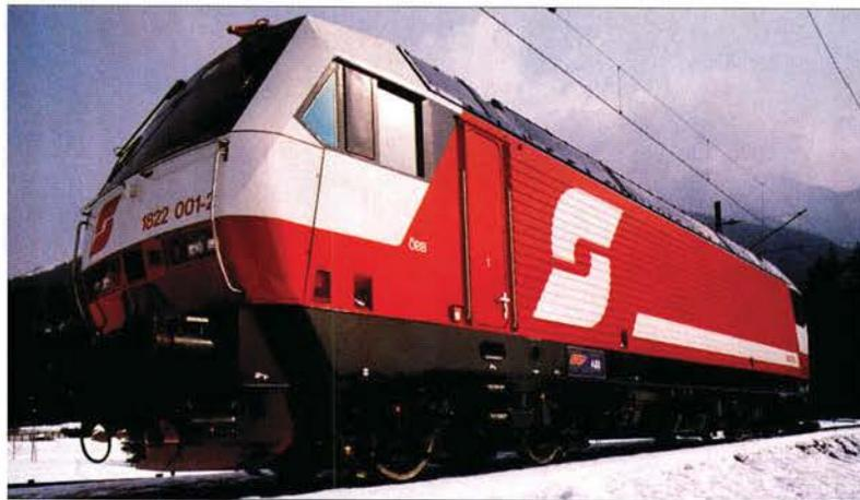
Die ÖBB-„Brenner-Lok“ für den Zweisystembetrieb 15 kV 16 2/3 Hz/3 kV = .
