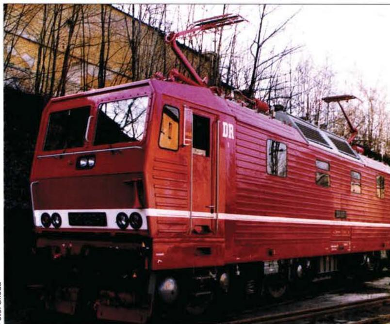
Die Zweisystemlokomotive der Baureihe 180 für die Deutsche Reichsbahn wurde von den Skoda-Werken in Pilsen für 3 kV =/15 kV 16 2/3 Hz gebaut. Die tschechische Version trägt die Reihenbezeichnung 372. Sie ist auf der Strecke Prag-Dečín-Dresden bzw. Leipzig und Berlin eingesetzt.
