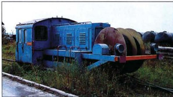
Ein Unikum des Zementwerkes Karsdorf, jedoch kein KEG-Fahrzeug: Eine Elektro-Kö mit eigenem Stromkabel.
