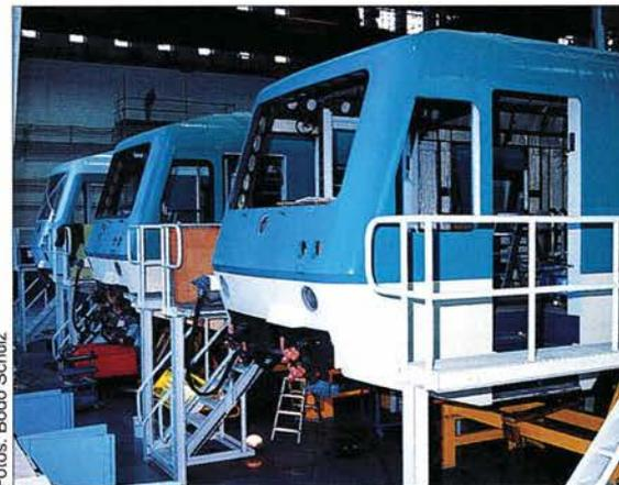
Nahverkehrstriebwagen 628.4 in Serienfertigung.
