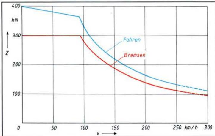
**Zugkraft-Geschwindigkeitsdiagramm des ICE für beide Triebköpfe zusammen.**
