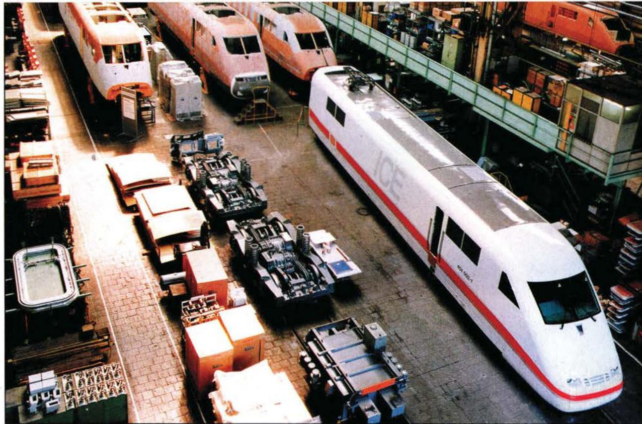
**Endmontage von ICE-Triebköpfen bei Krupp-Maschinenteknik**
