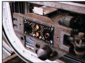
**Geöffnete Kurzkupplung zwischen Triebkopf und Mittelwagen**
