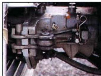
**Kurzkupplung zwischen Triebkopf und Mittelwagen**
