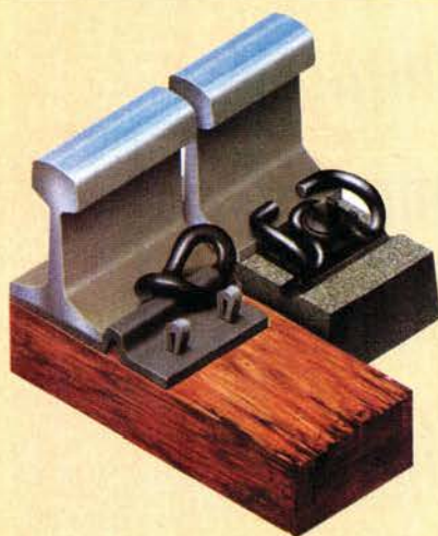
Befestigungen von Fahrschienen auf Holz- und Betonschwellen. Wichtig sind Festigkeit, Elastizität und einfache Montage.
