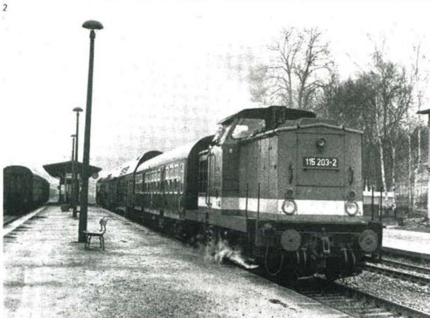
Motor 12 KVD 21 AI-4 mit einer Leistung von 736 kW (1000 PS). Anstelle des Heizkessels wird Ballast eingebaut und zum Warmhalten das Warmhaltegerät Heto 30. Weitere konstruktive Veränderungen kommen hinzu. Mit den ersten Prototypen ist Mitte 1987 zu rechnen. Der Serienumbau wird ab 1988 beginnen und sich über mehrere Jahre erstrecken. In den Umbau werden übrigens auch die in geringer Stückzahl vorhandenen Lokomotiven der BR 111 einbezogen.
