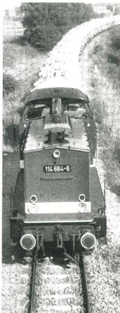
bungsträger für den Dieselmotor wurde im Oktober 1984 durch das Bw Halle G umgebaut. Mit dem Serienumbau ist ab 1988 zu rechnen. Die umgebauten Lokomotiven der Baureihe 106 erhalten die Bezeichnung Baureihe 104. Die bisherige Ordnungsnummer wird hier ebenfalls beibehalten.
