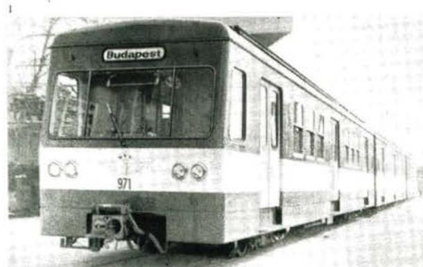
Bild 1 MXA-Triebzug für Budapest, Hersteller KLEW „Hans Beimler“ Hennigsdorf, Gesamtlänge 106 800 mm, Höchstgeschwindigkeit 80 km/h
