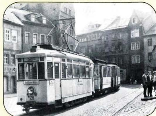
Bild 4 Der TW12 steht mit dem Bw 46 an der Endstelle Mühlthal (1959) zur Abfahrt bereit. Die Waggonfabrik Weimar fertigte diesen Triebwagen im Jahre 1928. 1964 wurde er zum Beiwagen 212 umgebaut und im Jahre 1974 im Raw Berlin-Schöneeweide rekonstruiert.
