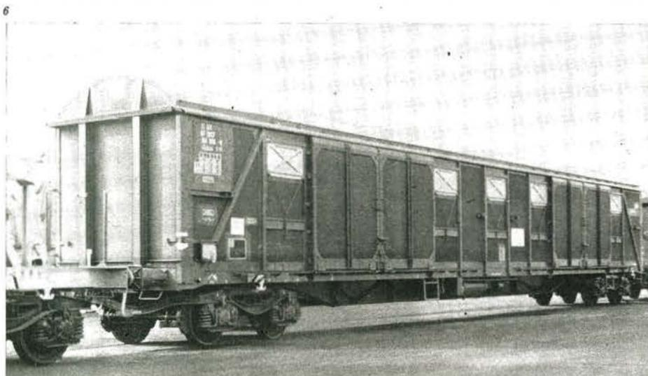
Bild 6 Einen **gedeckten Großraumgüterwagen** mit jeweils zwei zweiteiligen Seitenwandtüren stellte die französische Firma Arbel aus. Die Länge des Universalwagens, gemessen über Puffer, beträgt 21 700 mm, die Ladefläche ist mit 52,6 m<sup>2</sup> angegeben. Der Wert für die zulässige Geschwindigkeit beträgt 120 km/h.
