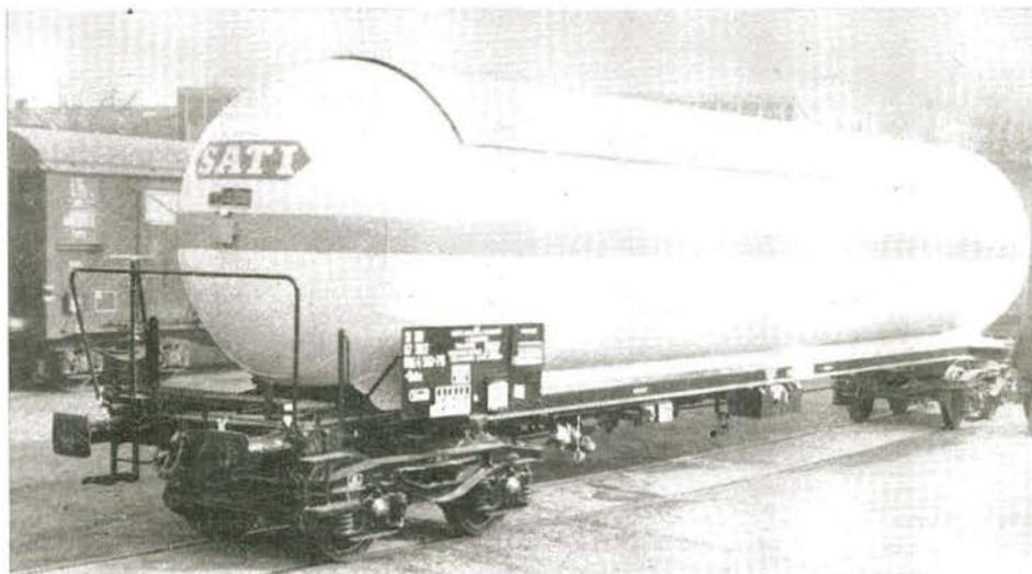
Bild 9: Die Firma Fauvet-Girel (Frankreich) stellte einen vierachsigen Behälterwagen in Edelstahl aus, der eine pneumatische Entleerungsanlage hat und vor allem für den Transport von granuliertem Polyäthylen vorgesehen ist. Das Fassungsvermögen dieses großräumigen Fahrzeugs beträgt 98 m<sup>3</sup>, die Gesamtlänge 19250 mm.
