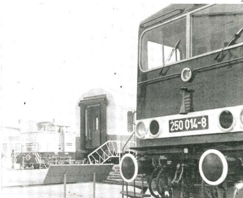
**Bild 1** Die ausgestellte **Ellok der Baureihe 250** des KLEW Hennigsdorf stammt aus der Serienproduktion, die gegenüber der vor zwei Jahren vorgestellten Musterlokomotive äußerlich u. a. durch eine Anordnung des mittleren Scheinwerfers und eine veränderte Fensterpartie geändert wurde. Im Hintergrund die Diesellok V 60 mit Funkfernsteuerung.
