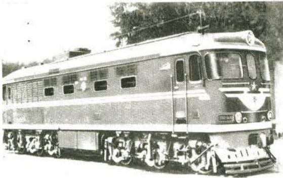
Bild 1 Die sechsachsige Diesellokomotive des Typs „TEP-60“ der SŽD, eine Maschine für den Reisezugdienst
