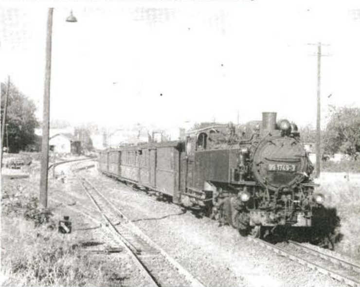
Bild 1 Ausfahrt aus dem Bf „Zittau-Vorstadt“; das linke Ausziehgleis ist noch ein Überrest aus der Zeit der 2gleisigen Streckenführung
